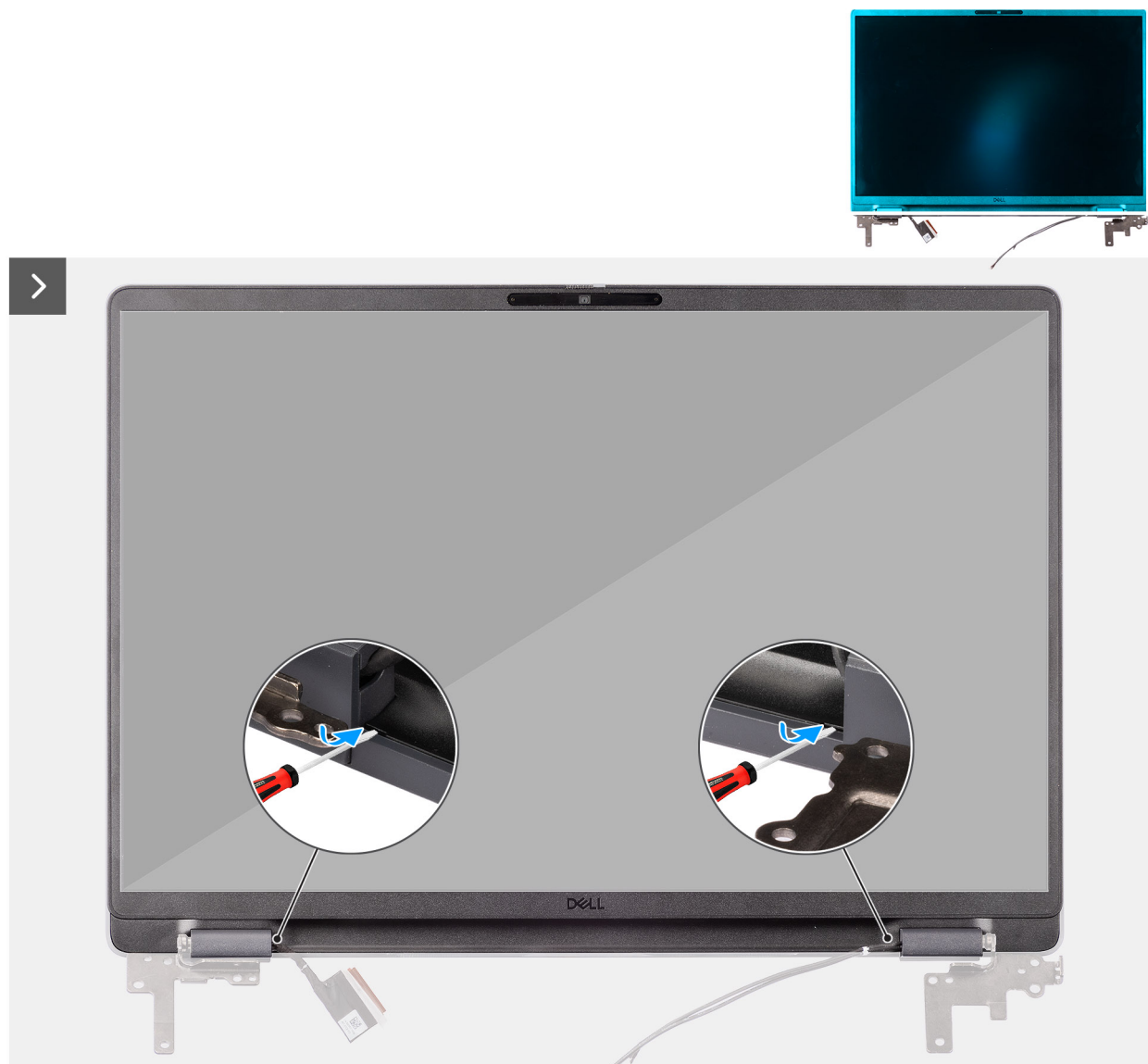
Rysunek 67. Removing the display bezel
