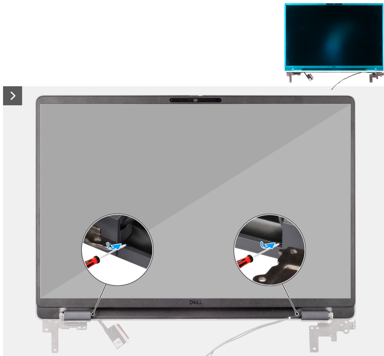
Rysunek 77. Removing the display bezel
