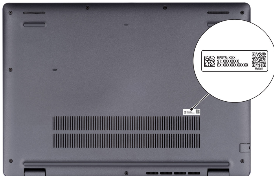
Rysunek 6. Lokalizacja etykiety z kodem Service Tag / kodem obsługi ekspresowej
