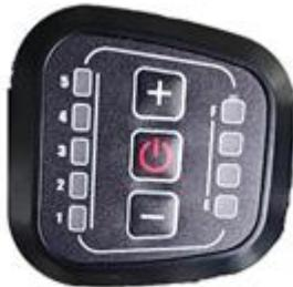
Bisiklet, ekrandan seçilebilen beş pedal yardımı seviyesine sahiptir. Ekran ile bisikleti açabilir, pilin kalan şarj miktarını görüntüleyebilir ve pedal yardımını ayarlayabilirsiniz.
