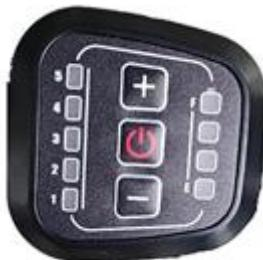
Велосипед оснащен пятью уровнями помощи при педалировании, которые можно выбрать на дисплее. С помощью дисплея включается велосипед, отображается остаточный заряд батареи и регулируется помощь при педалировании.
