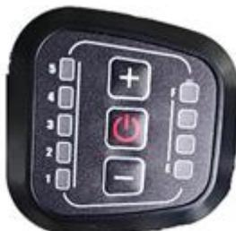
Rower jest wyposażony w pięć poziomów wspomagania pedałowania, które można wybrać na wyświetlacz. Za pomocą wyświetlacza włącza się rower, wyświetla ilość pozostałego ładunku baterii i reguluje wspomaganie pedałowania.
