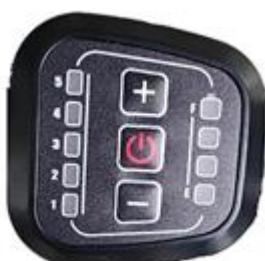
La bicicleta está equipada con cinco niveles de asistencia al pedaleo, seleccionables en la pantalla. Con la pantalla se enciende la bicicleta, se visualiza la cantidad de carga restante de la batería y se regula la asistencia al pedaleo.
