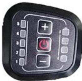
Bicicleta este echipată cu cinci niveluri de asistență la pedalare, selectabile pe afișaj. Cu afișajul se pornește bicicleta, se vizualizează cantitatea de încărcare rămasă a bateriei și se regleză asistența la pedalare.
