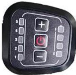
Das Fahrrad ist mit fünf Unterstützungsstufen für das Treten ausgestattet, die auf dem Display ausgewählt werden können. Mit dem Display wird das Fahrrad eingeschaltet, der verbleibende Batteriestand angezeigt und die Tretunterstützung eingestellt.
