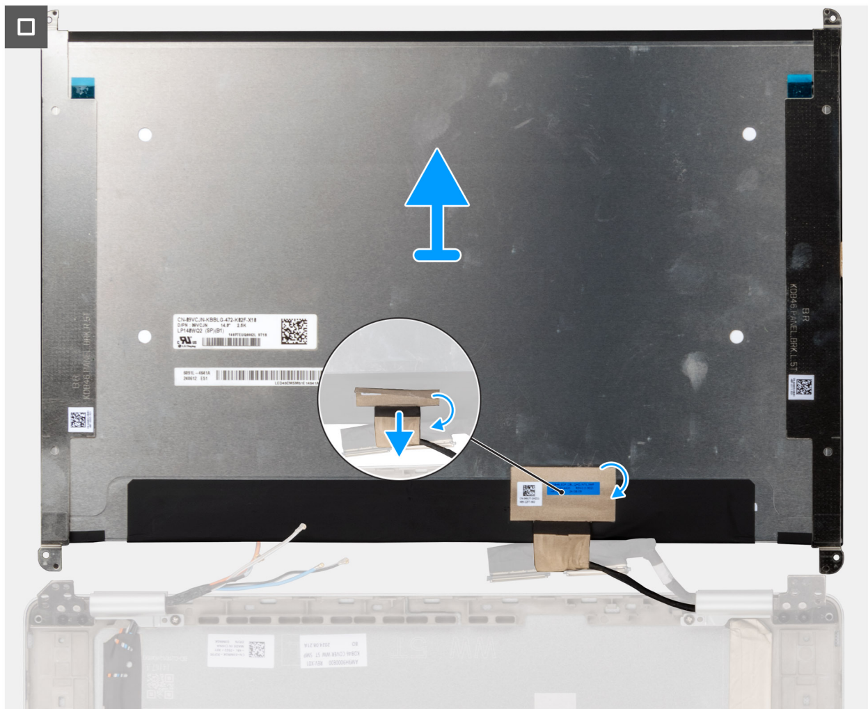
Afbeelding 50. De beeldschermkabel uit het achterpaneel verwijderen
