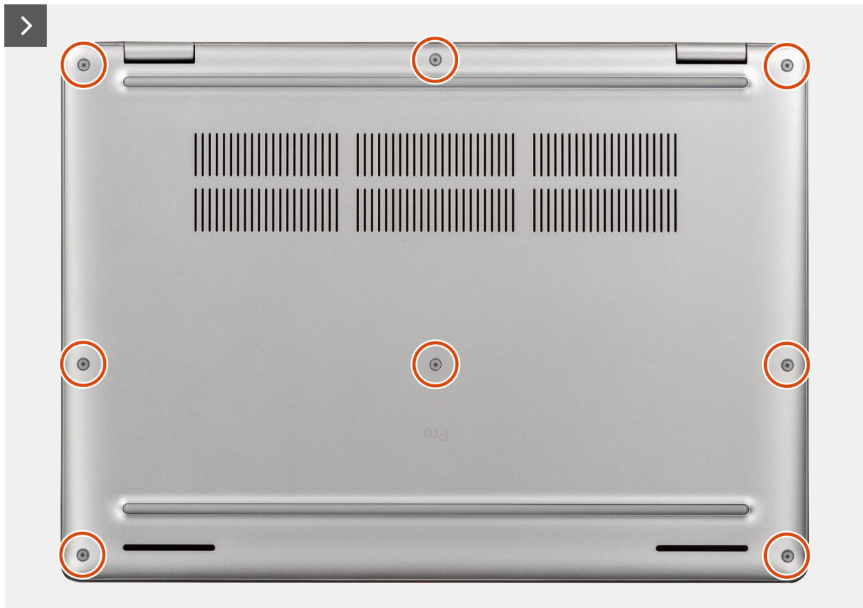
Afbeelding 19. De onderplaat verwijderen
