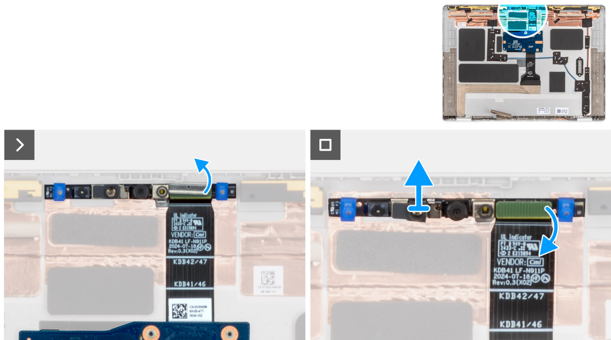
Afbeelding 56. De MIPI-camera verwijderen
