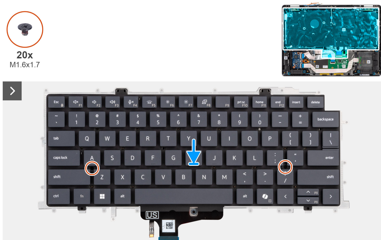
Afbeelding 81. Het toetsenbord installeren
