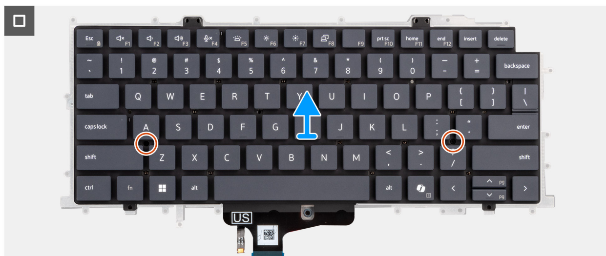
Afbeelding 80. Het toetsenbord verwijderen
