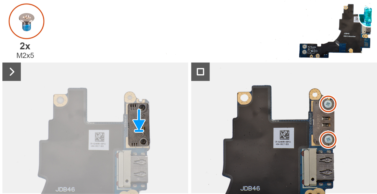
Afbeelding 54. Installing the left USB Type-C module
