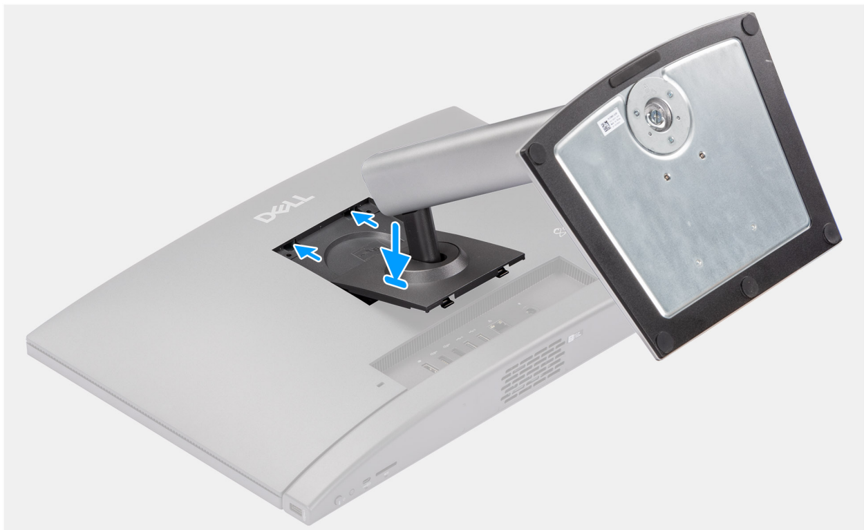
Afbeelding 15. De in hoogte verstelbare standaard (HAS) installeren
