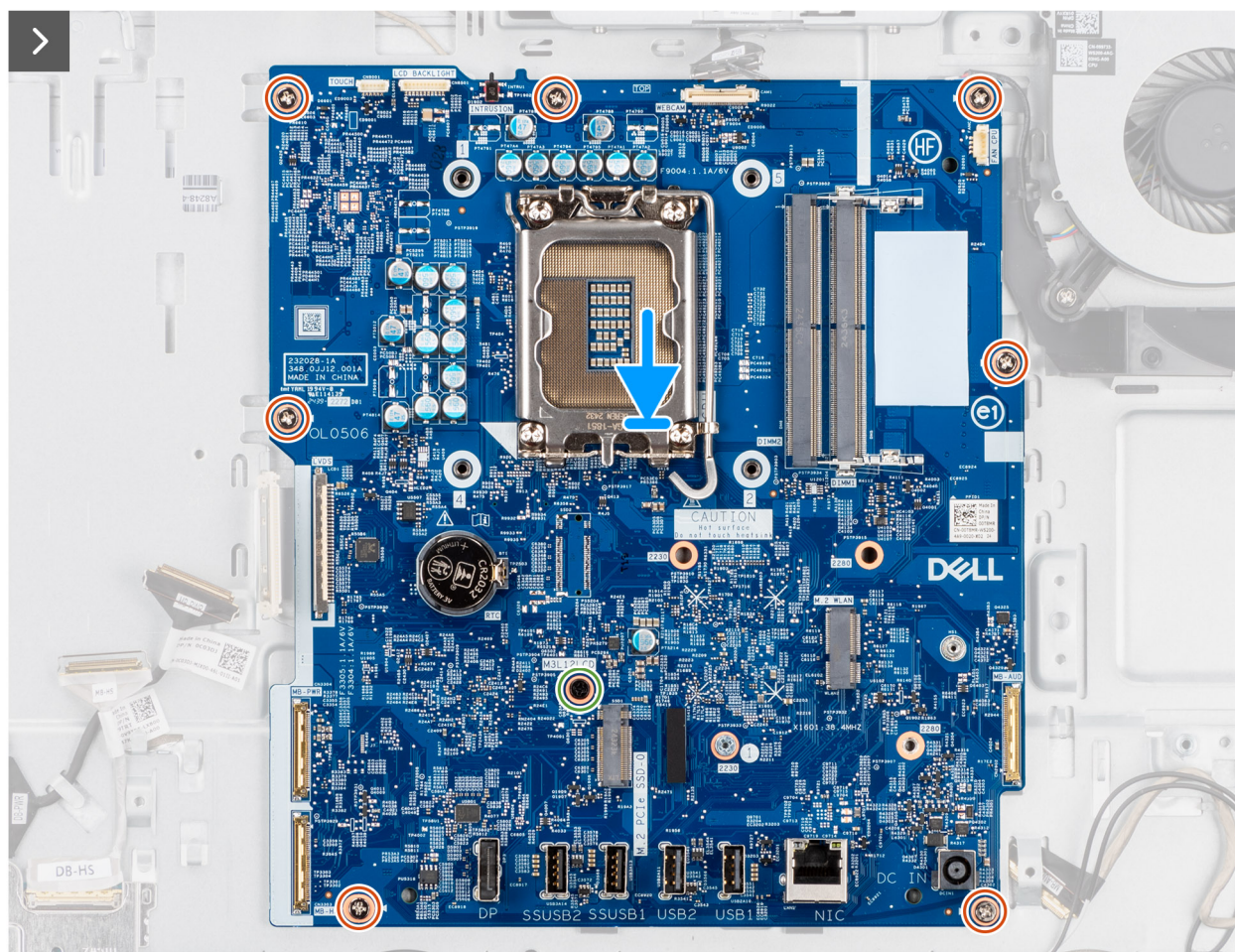
Afbeelding 50. De systeemkaart installeren
