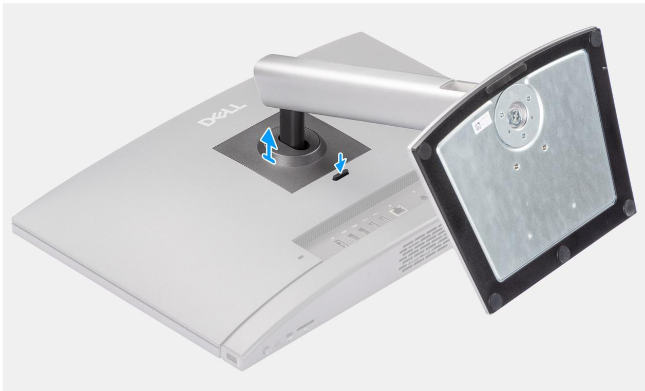
Abbildung 13. Entfernen des höhenverstellbaren Ständers (HAS)
