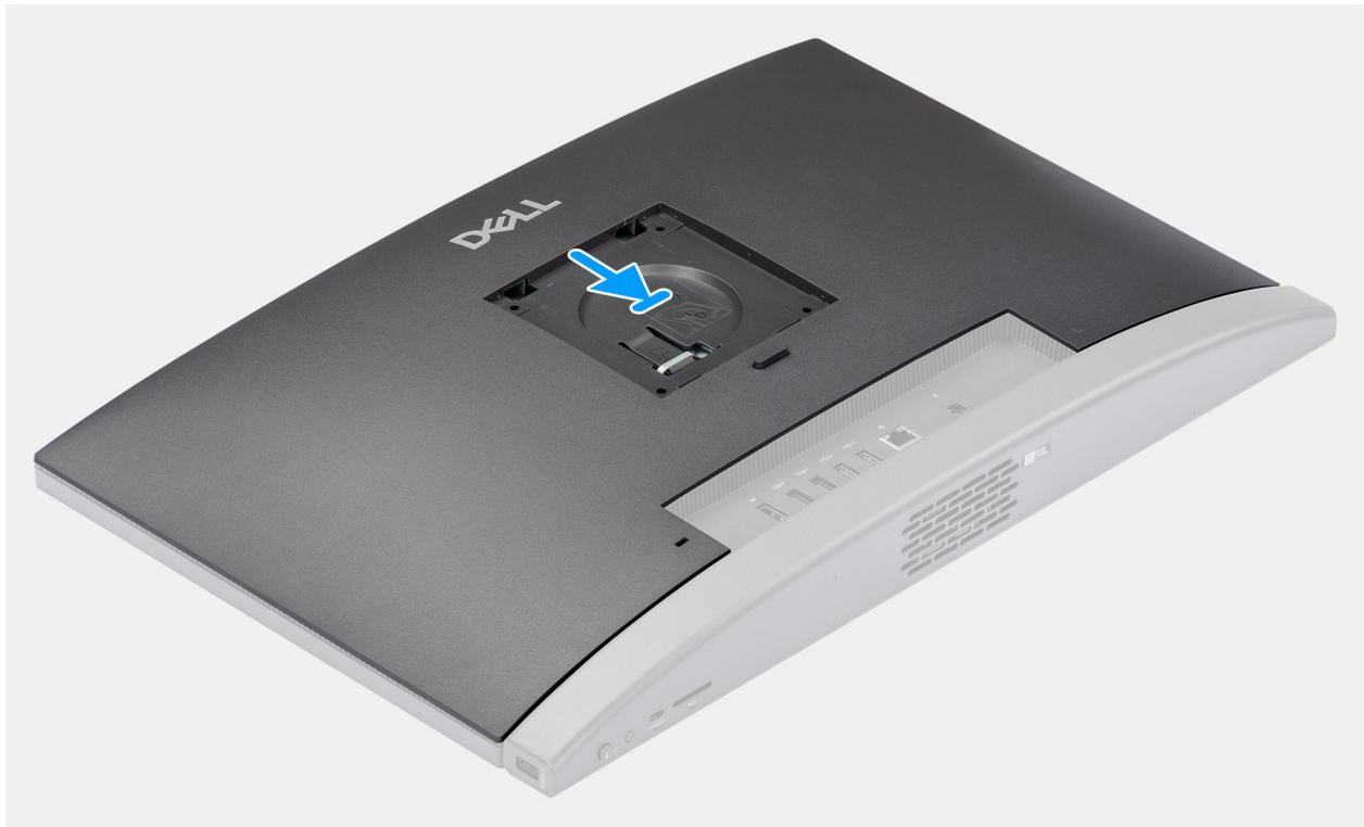
**Abbildung 18. Einbauen der Rückabdeckung**
