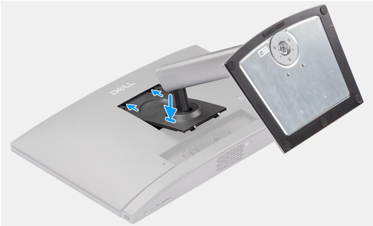
Abbildung 15. Installieren des höhenverstellbaren Ständers (HAS)
