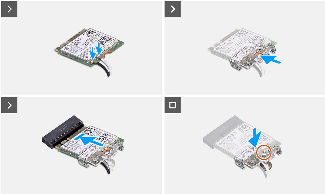
Abbildung 24. Installieren der Wireless-Karte
