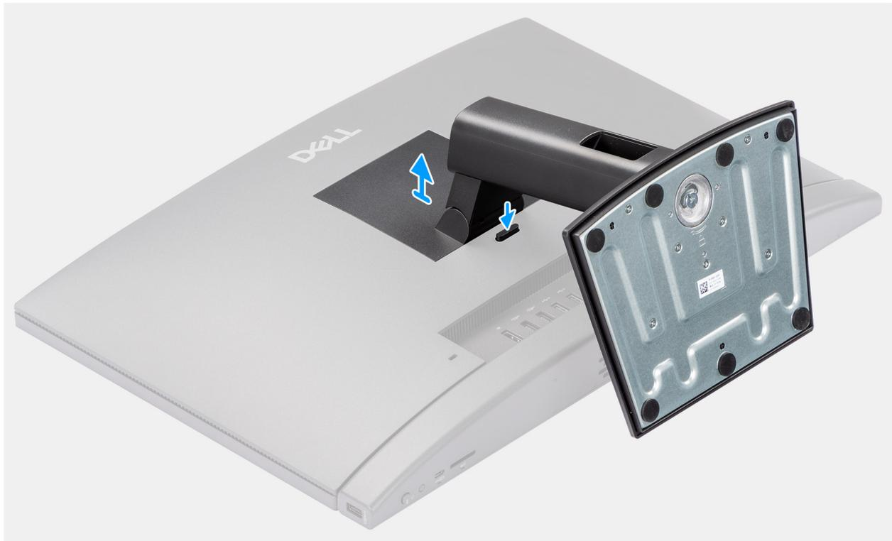
**Abbildung 14. Entfernen des feststehenden Ständers**
