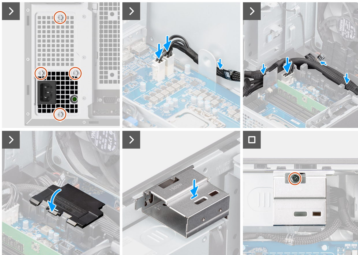
Figure 56. Installation du bloc d'alimentation de 1500 W
