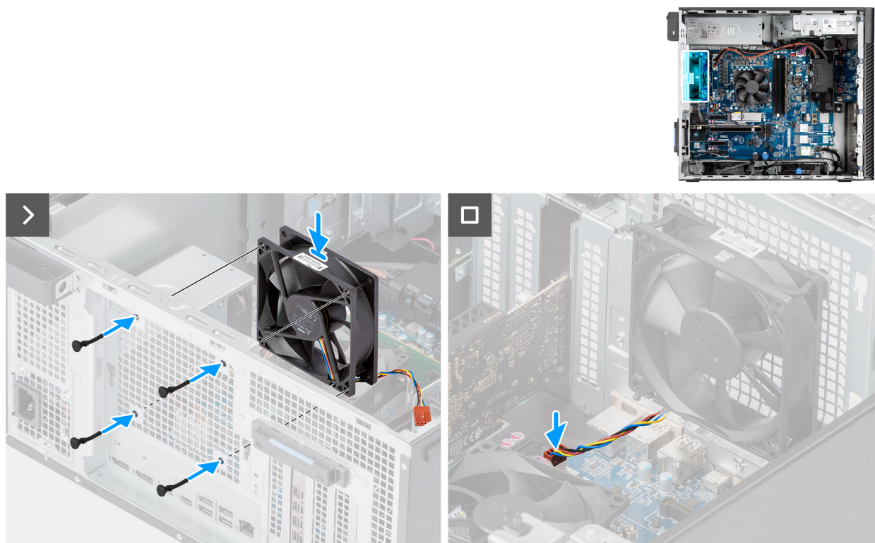
Figure 50. Installation du ventilateur arrière pour les ordinateurs à bloc d'alimentation de 360 W
