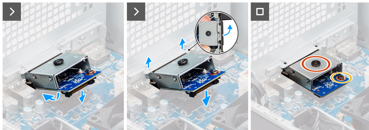
Figure 87. Installation du module VGA en option
