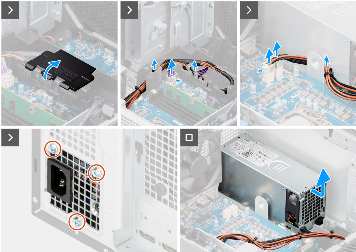
Figure 58. Retrait du bloc d'alimentation de 360 W
