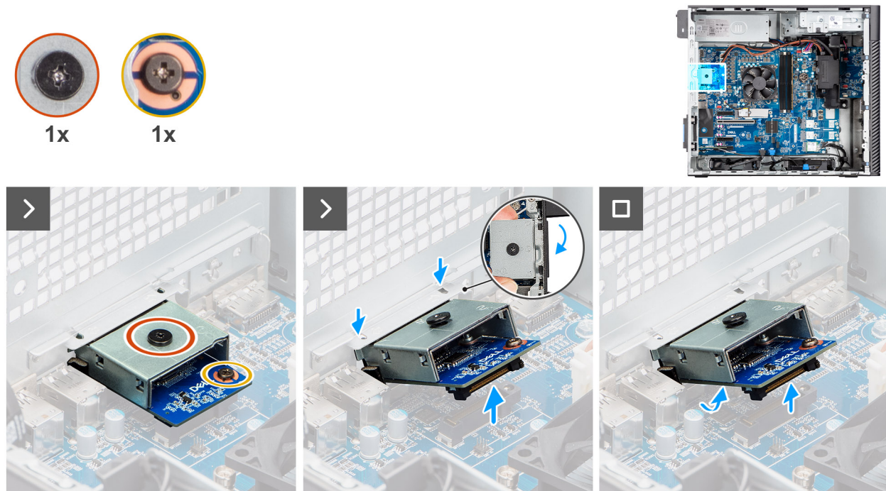
Figure 71. Retrait du module HDMI en option
