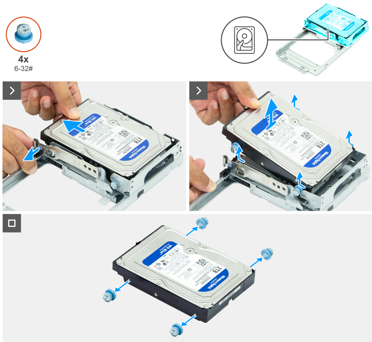
Afbeelding 29. De harde schijf verwijderen
