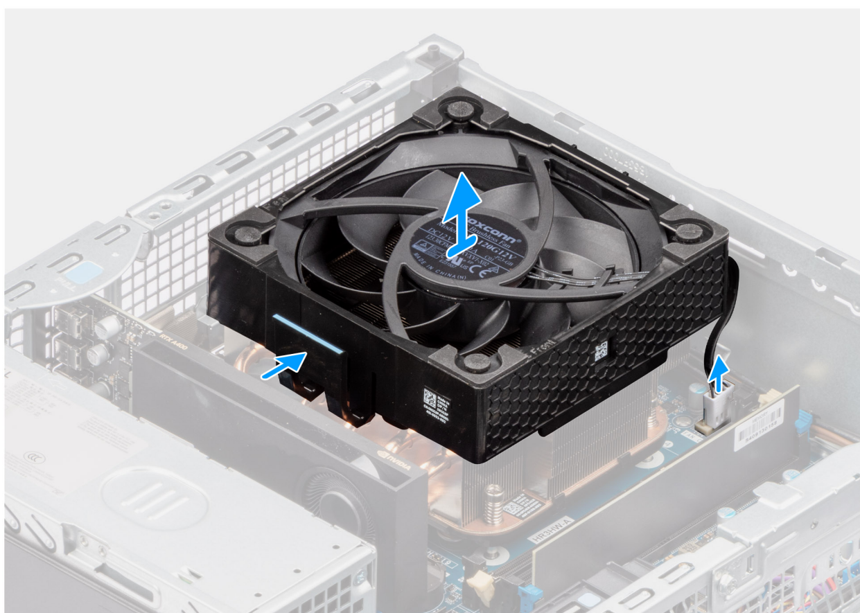
Afbeelding 51. De processorventilator verwijderen
