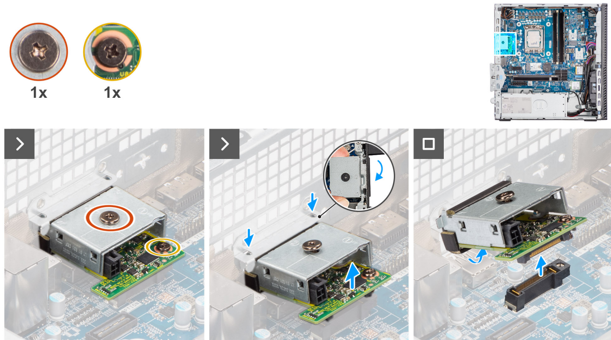
Figure 67. Retrait du module Thunderbolt en option
