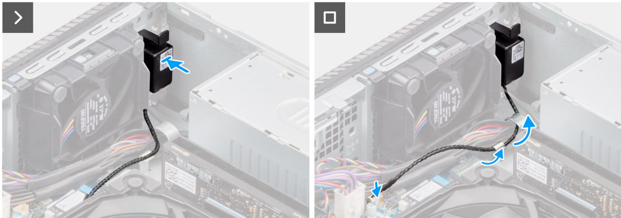
Figure 26. Installation du haut-parleur interne
