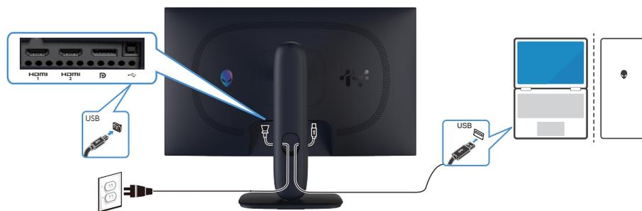
**Figura 10. Ligar o cabo USB Tipo B (Tipo B para Tipo A)**
