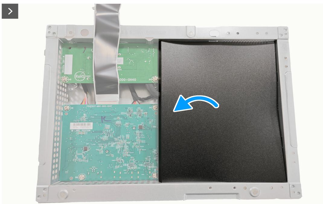
**Figura 30. Remover a placa do sistema e a placa de alimentação**
