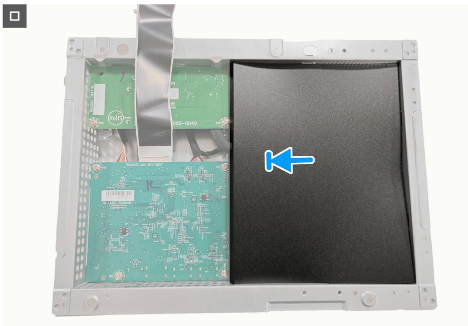
**Figura 35. Instalar a placa do sistema e a placa de alimentação**
