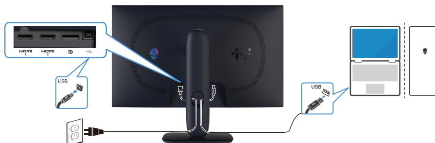
Figure 30. Ligar o cabo USB Tipo B (Tipo B para Tipo A)
