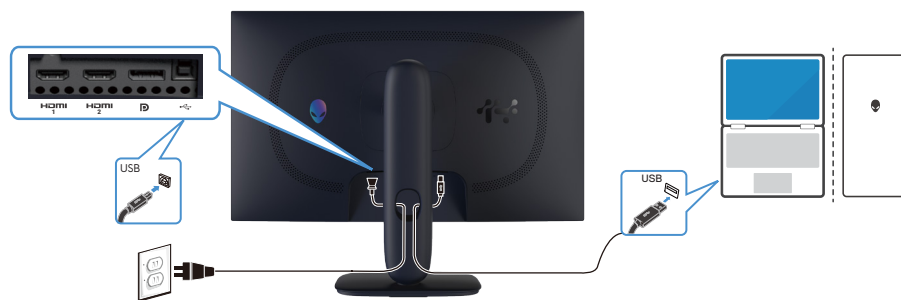
Figura 10. Collegamento del cavo USB tipo B (tipo B-tipo A)
