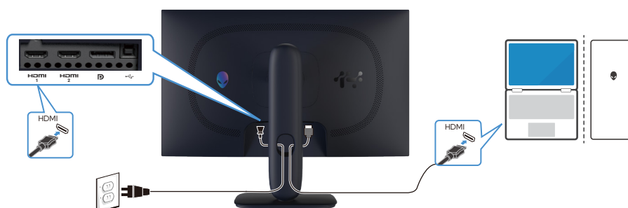
Figura 9. Collegamento del cavo HDMI
