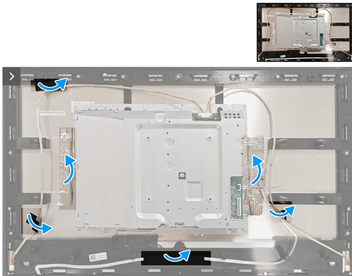
Figura 20. Rimozione della schermatura metallica
