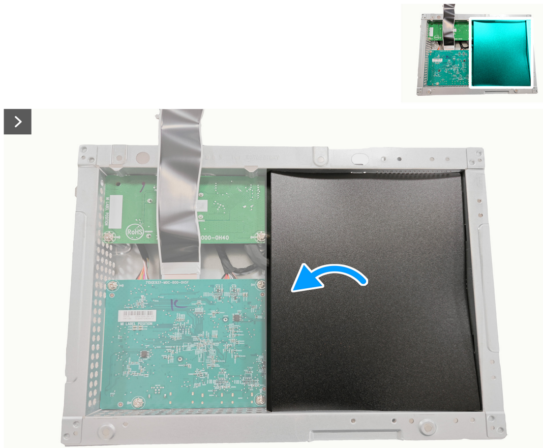
Figura 30. Rimozione della scheda di sistema e della scheda di alimentazione
