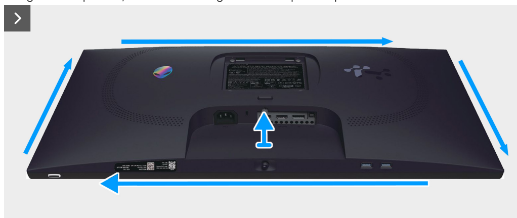
Figura 14. Rimozione del coperchio posteriore
