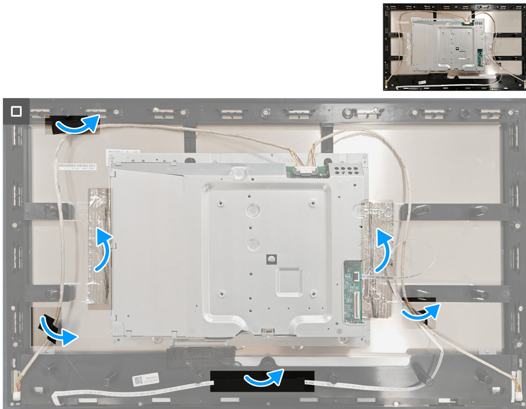
Figura 29. Installazione della schermatura metallica
