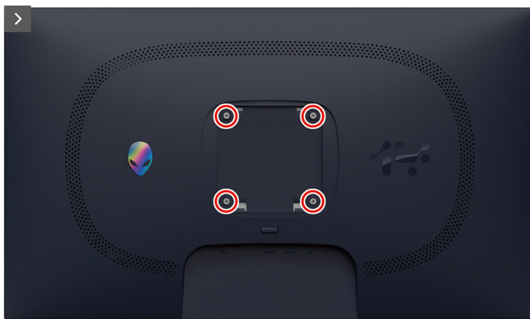
Figura 13. Rimozione del coperchio posteriore
