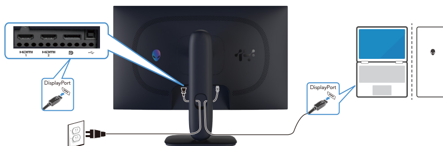
Figura 8. Collegamento del cavo DisplayPort (DP a DP)
