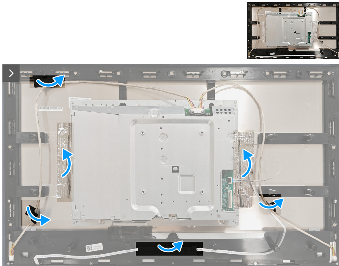
Figura 10. Quitar la protección metálica
