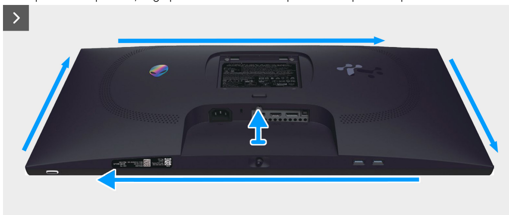
Figura 4. Quitar la cubierta posterior
