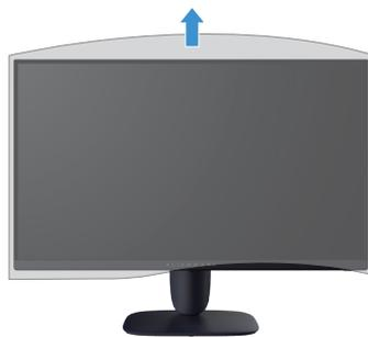
**Figure 18. Soulevez le couvercle de protection du moniteur**
