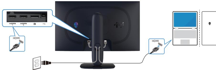
**Figure 29. Branchement du câble HDMI**
