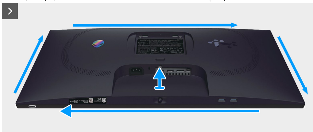
Figure 4. Enlever le couvercle arrière
