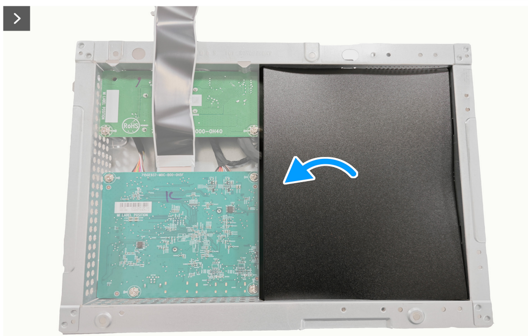
Figure 20. Enlever la carte du système et la carte d'alimentation
