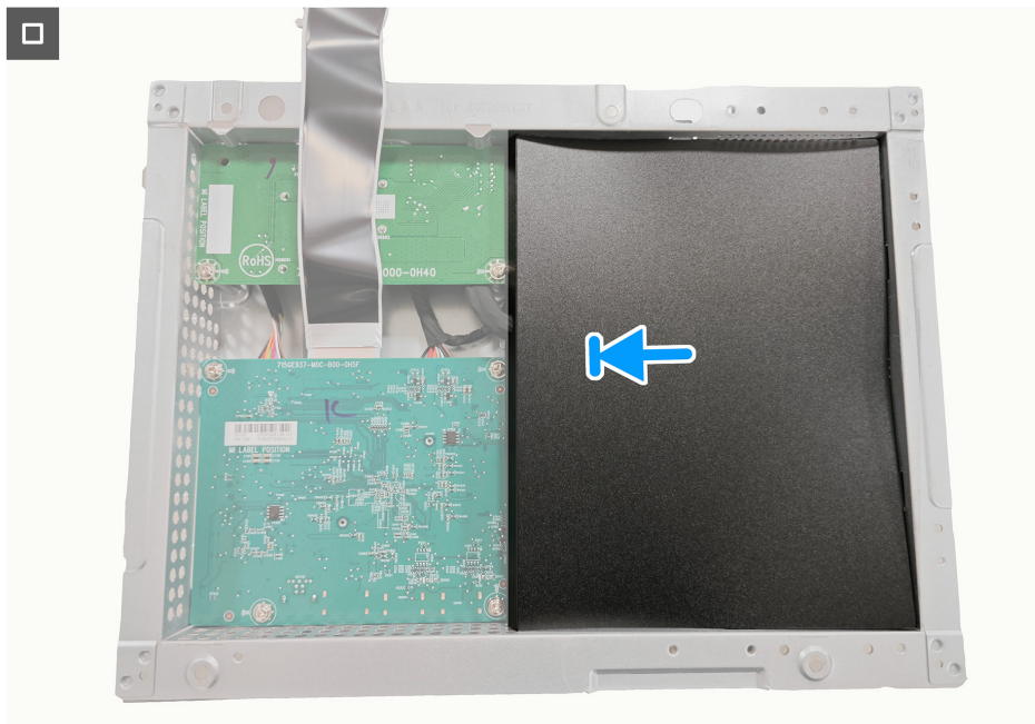
Figure 25. Installer la carte du système et la carte d'alimentation
