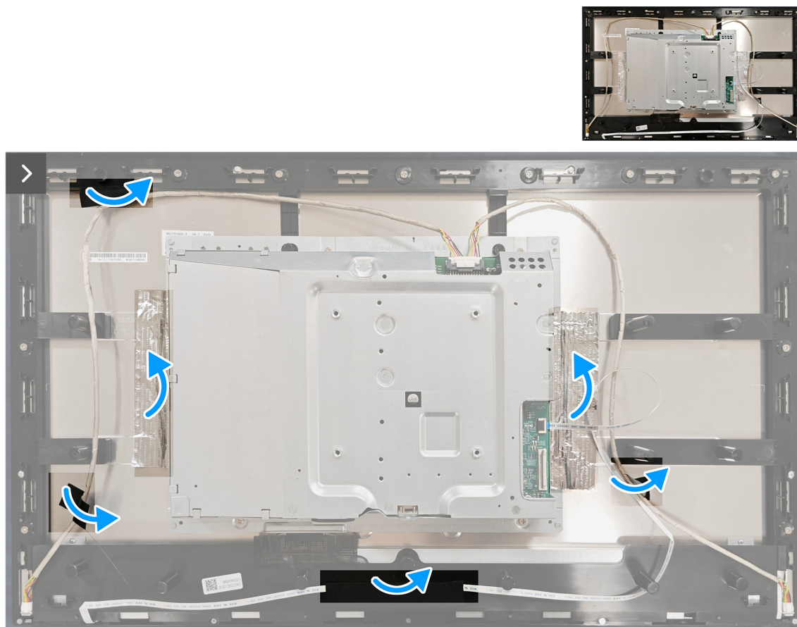
Figure 10. Enlever le blindage métallique
