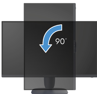
Figure 23. Gegen den Uhrzeigersinn drehen
