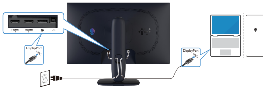
Figure 28. DisplayPort-Kabel (DP auf DP) anschließen
