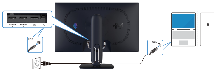
Figure 30. Das USB-Type-B-Kabel (Type-B auf Type-A) anschließen
