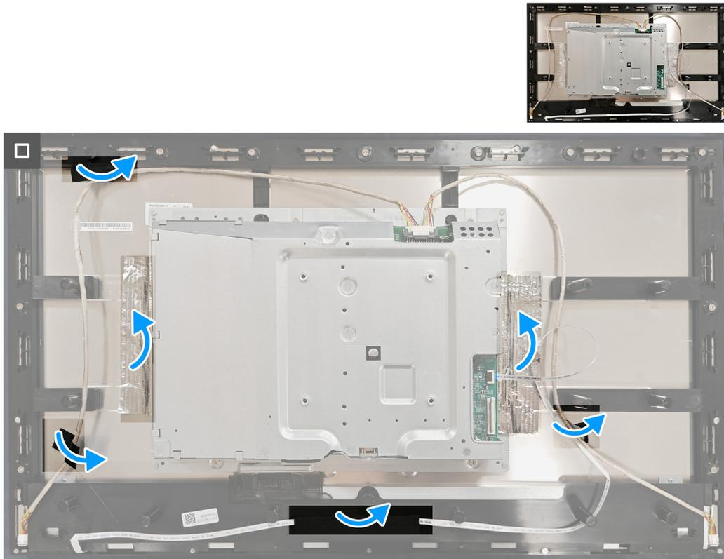
**Figure 29. Installer le blindage métallique**
