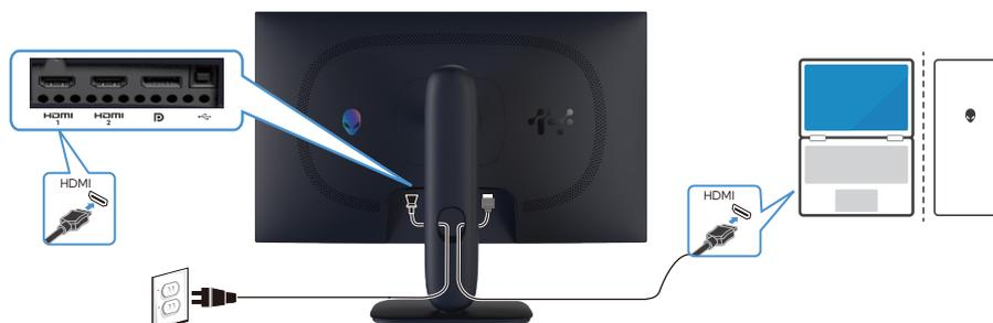
Figure 9. Branchement du câble HDMI
