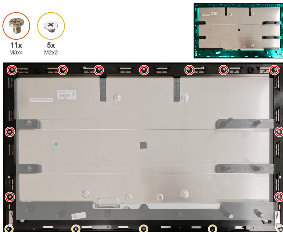
Rysunek 26. Zdejmowanie ramki środkowej
