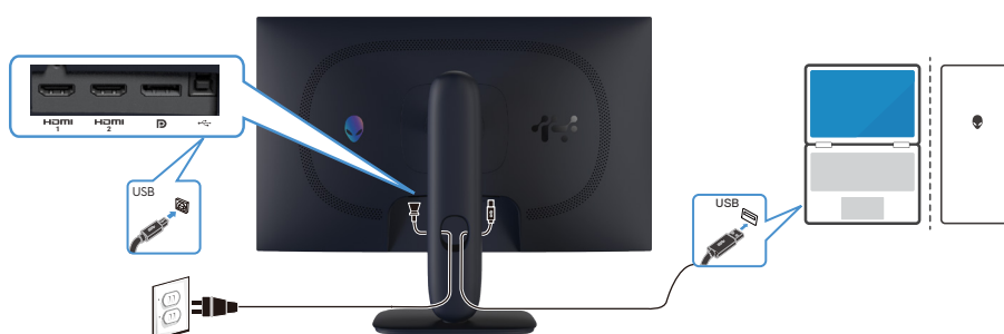
דמות 30. חיבור כבל USB Type-B (Type-B ל-Type-A).
