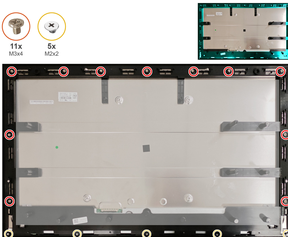
Figura 37. Instalar el marco central
