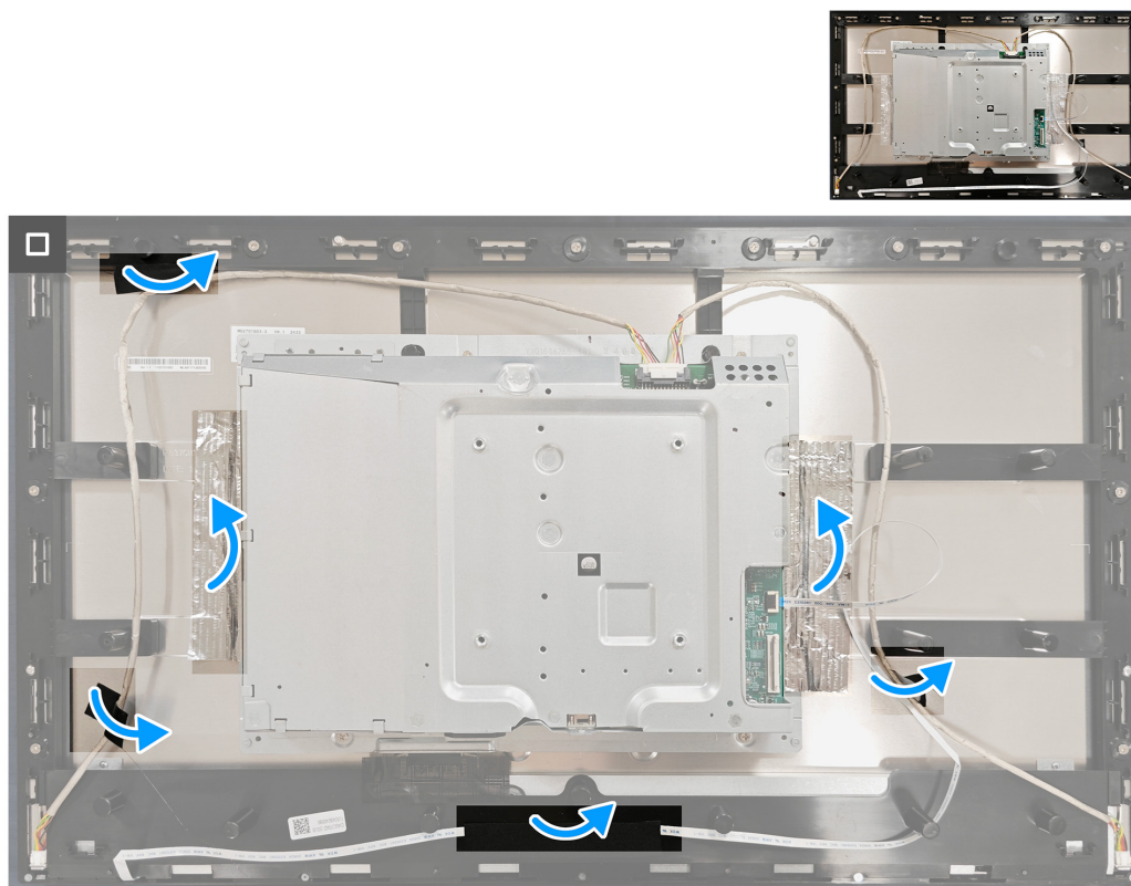
Figura 29. Instalar la protección metálica
