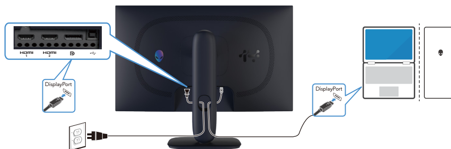
Figura 8. Conectar el cable DisplayPort (DP a DP)
