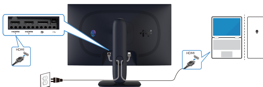
Figura 9. Conectar el cable HDMI
