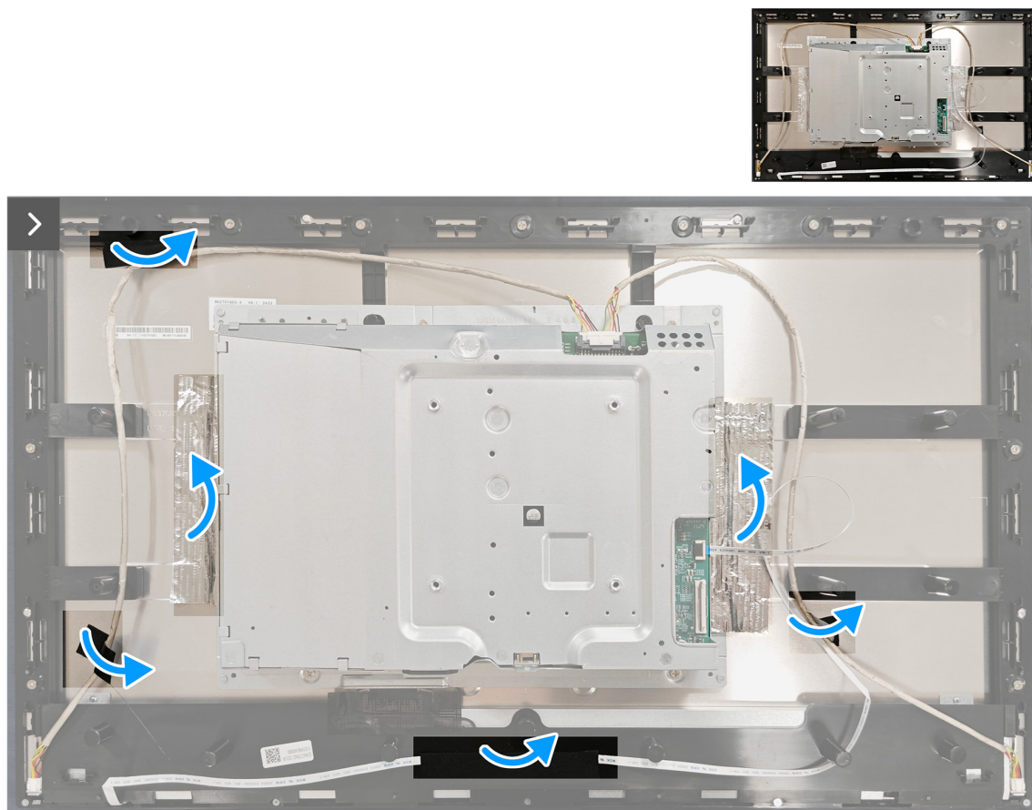
Figura 20. Quitar la protección metálica
