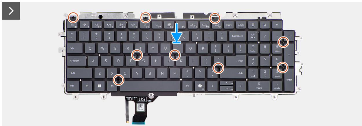
Figure 90. Installation du clavier
