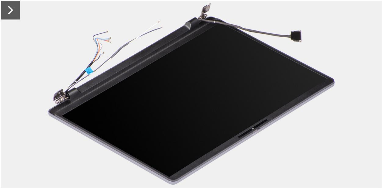
**Figure 53. Installation de l'assemblage d'écran**
