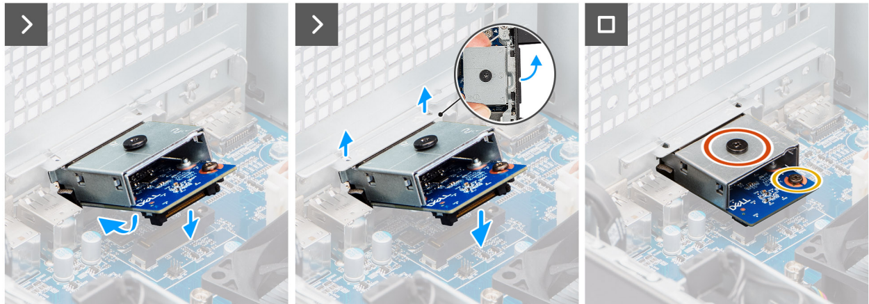
Afbeelding 87. De optionele VGA-module installeren.
