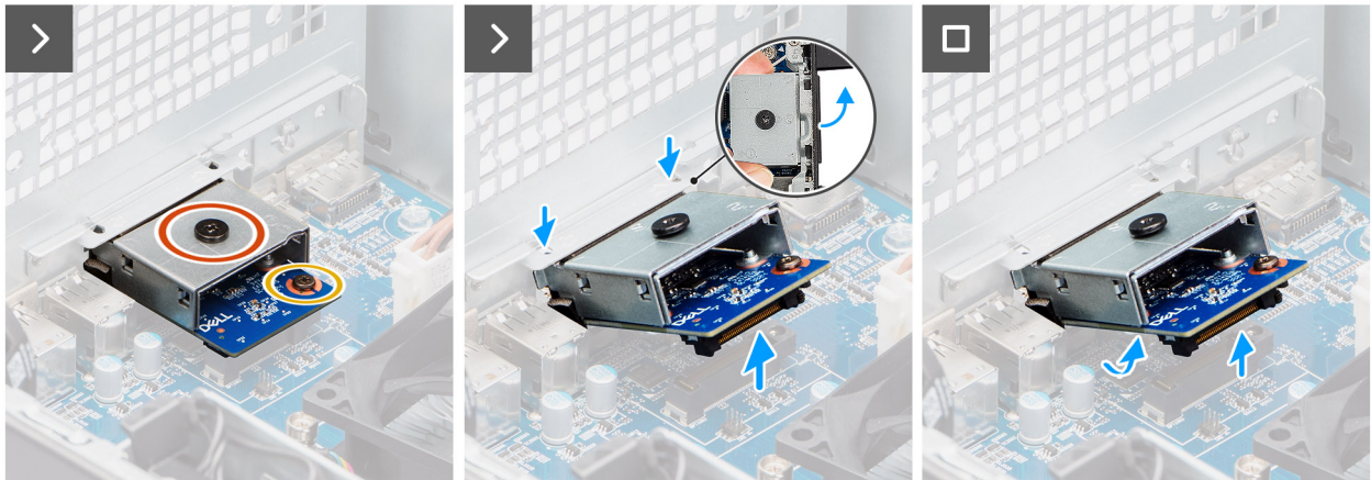
Afbeelding 85. De optionele VGA-module verwijderen
