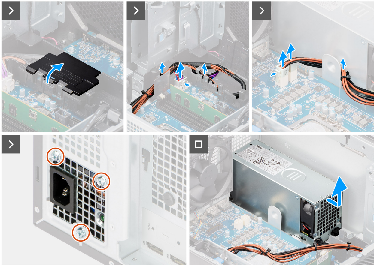
Afbeelding 57. De voedingseenheid van 360 W verwijderen
