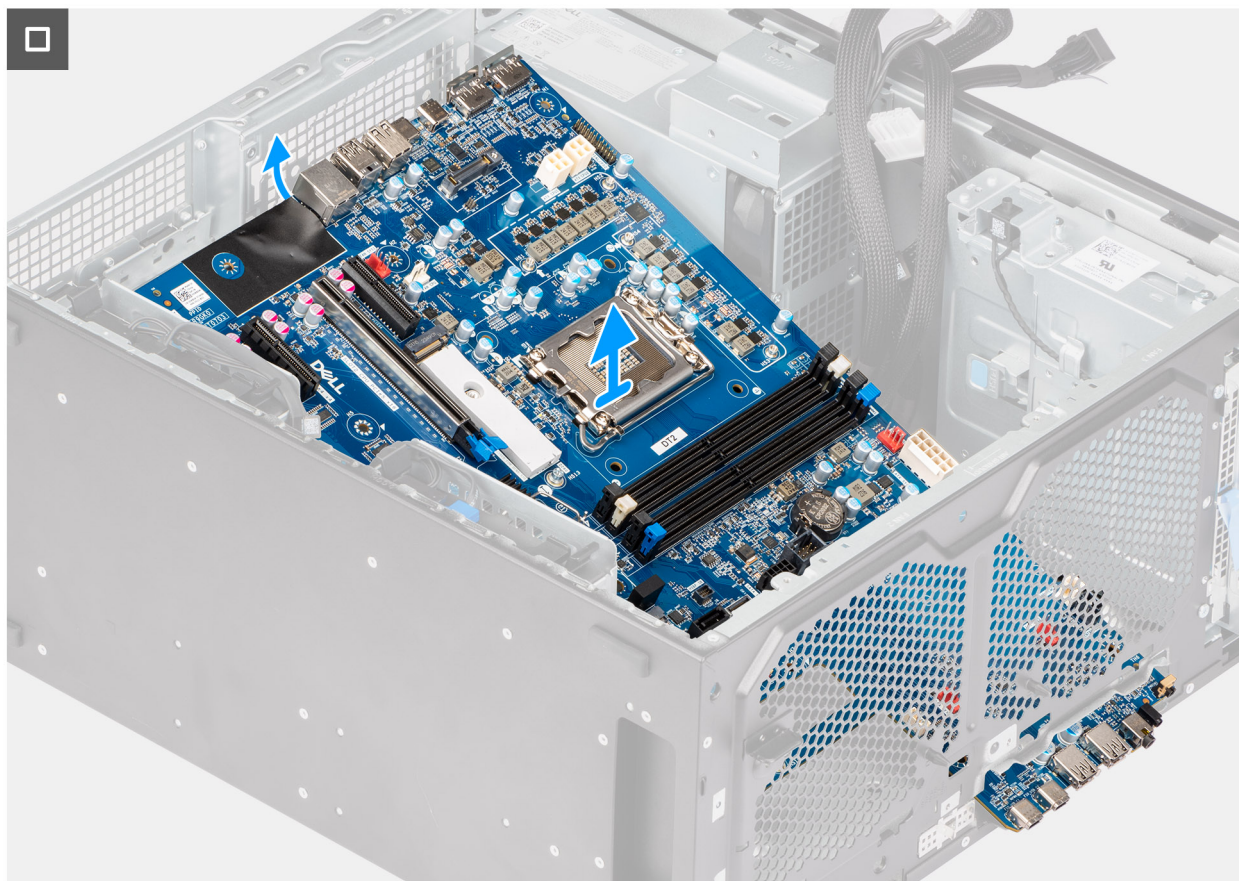
Afbeelding 92. De systeemkaart verwijderen
