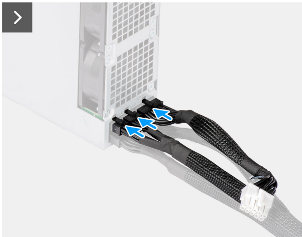
Afbeelding 55. De voedingseenheid van 1500 W plaatsen
