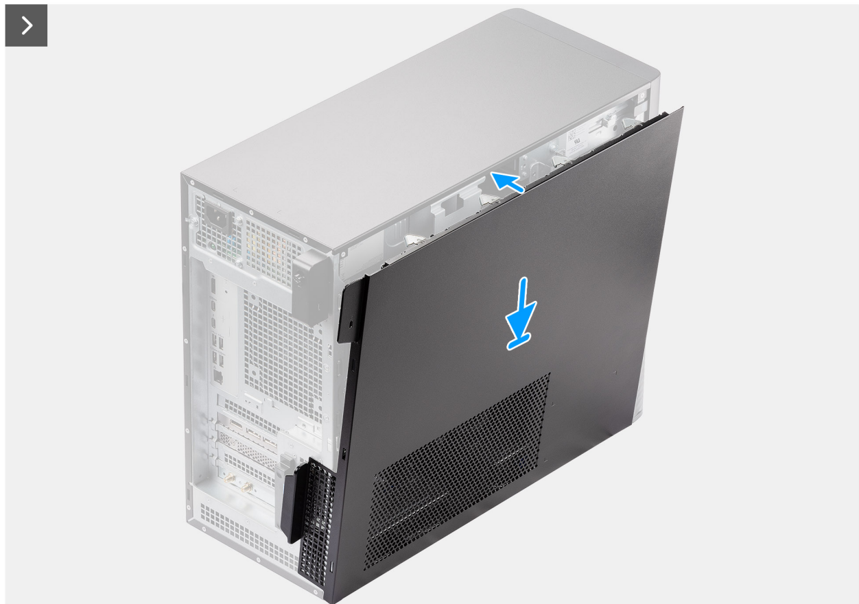
Afbeelding 11. De zijplaat plaatsen
