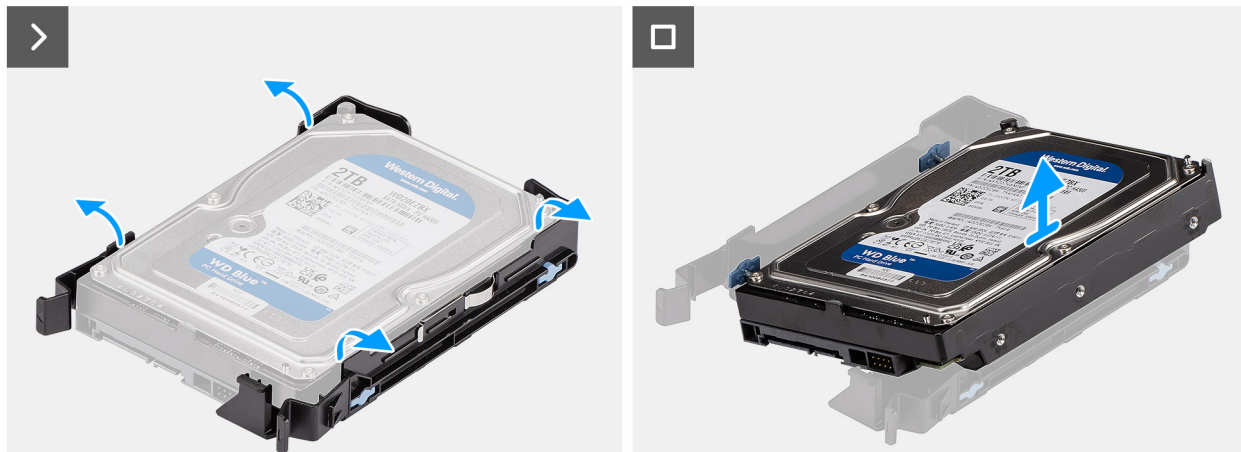
Afbeelding 27. De beugel van de 3,5-inch harde schijf verwijderen
