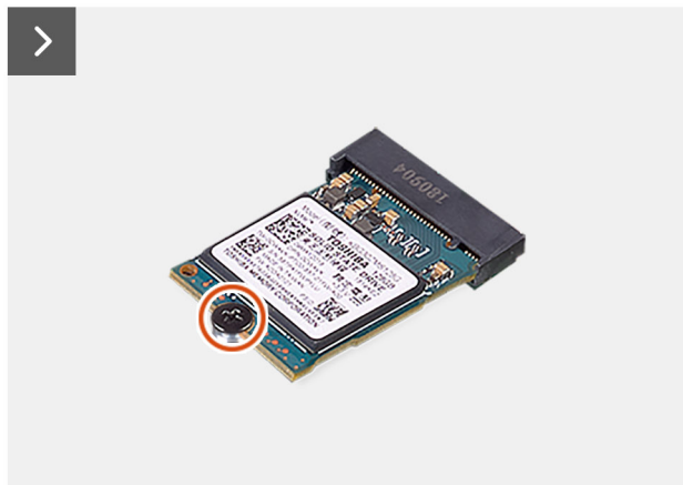
Afbeelding 31. De M.2 2230 PCIe SSD verwijderen
