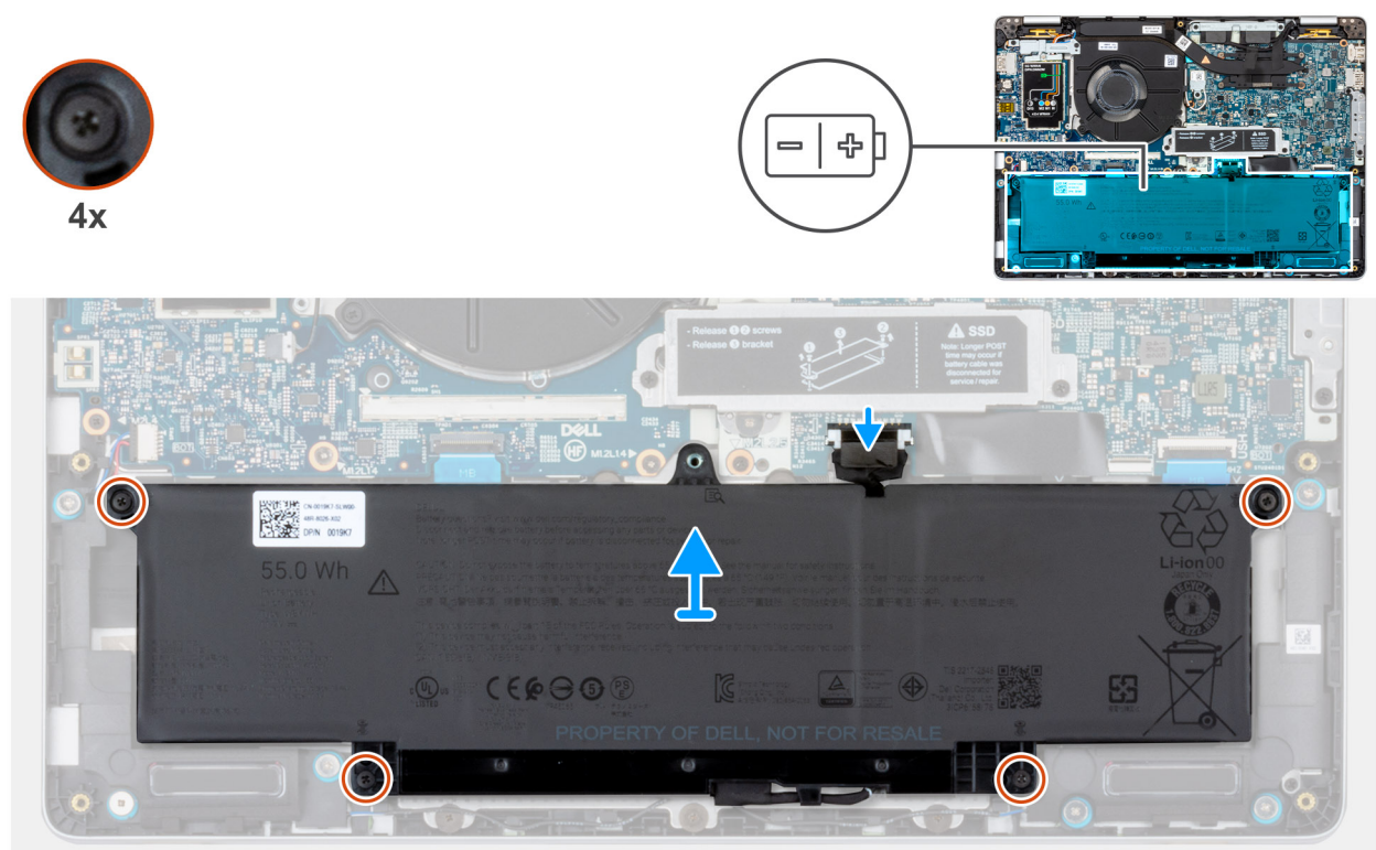
Afbeelding 10. De batterij installeren
