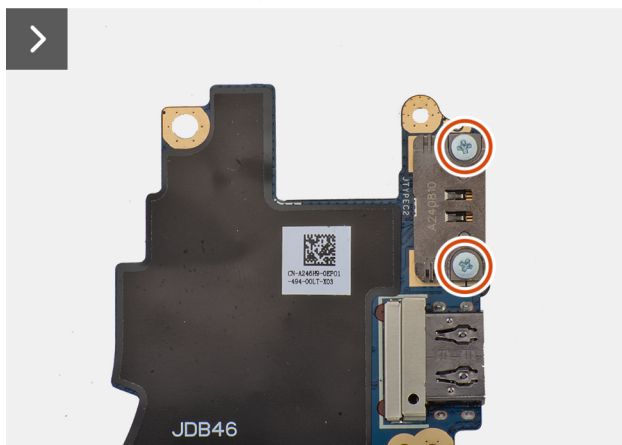
Afbeelding 50. De linker USB Type-C-module verwijderen
