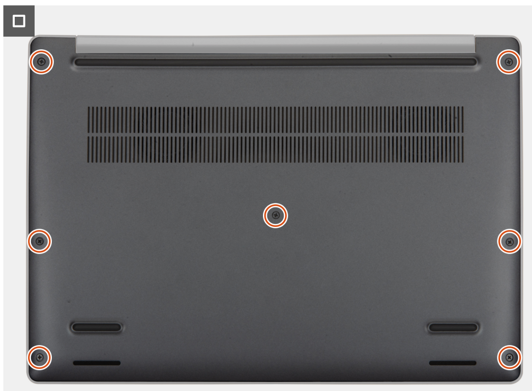
Afbeelding 19. De geborgde schroeven vastdraaien
