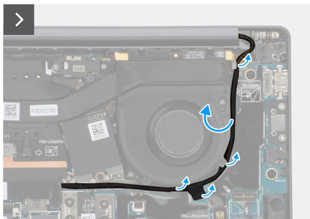
Afbeelding 28. De linkerventilator verwijderen
