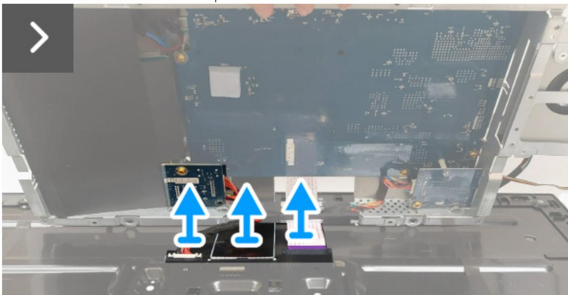
**Figura 12. Remover a proteção metálica**
