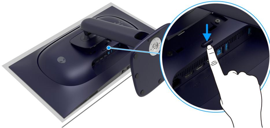
**Figura 30. Mantenga pulsado el botón de extracción del soporte**
