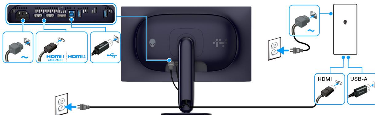
Figura 28. Conexión HDMI
