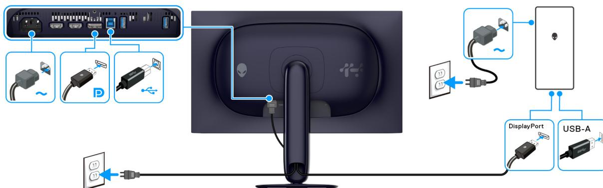
Figura 27. Conexión DisplayPort
