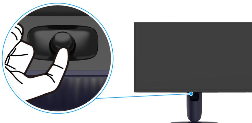
Figura 34. Uso del control de joystick
