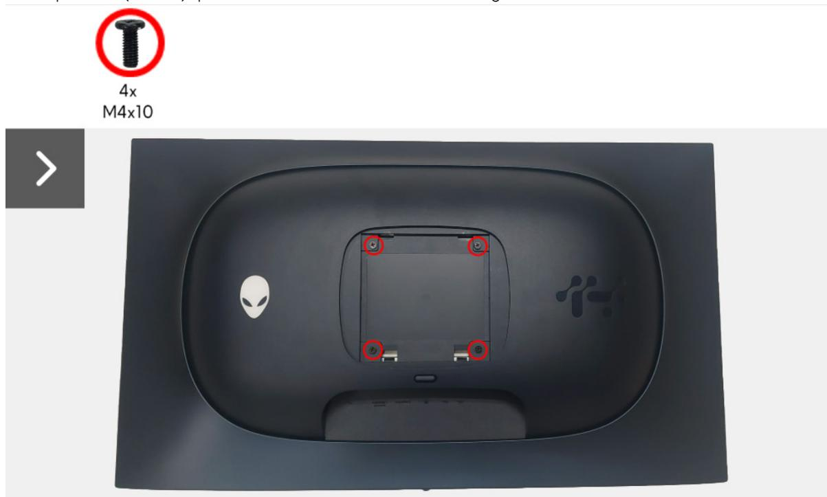
**Figure 4. Retirer le couvercle arrière**
