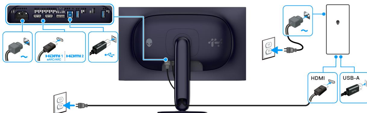
Figure 28. Connexion HDMI
