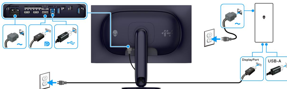
Figure 27. Connexion DisplayPort
