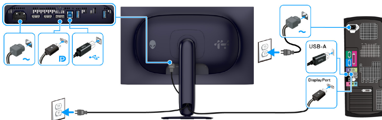
Obrázek 8. Připojení kabelu DisplayPort
