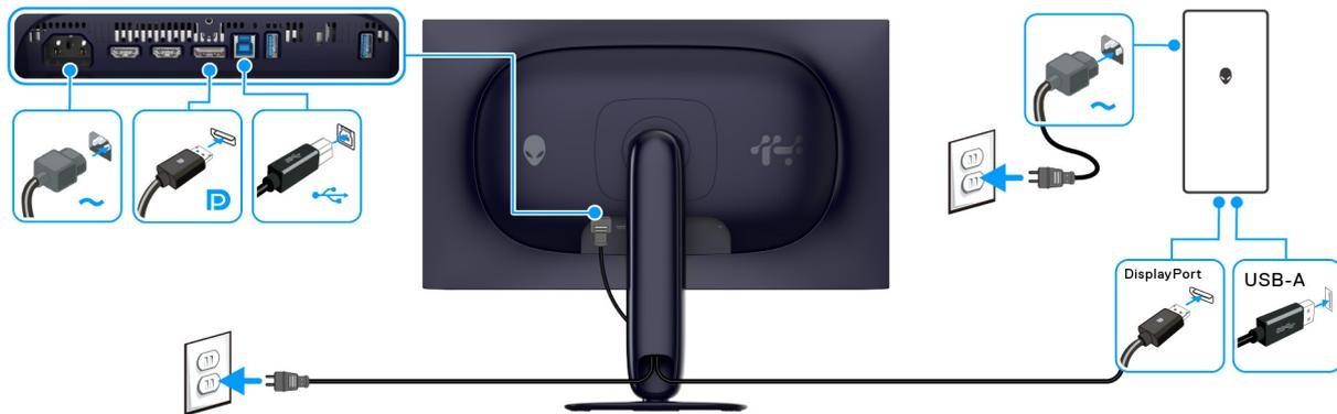
Abbildung 27. DisplayPort Verbindung
