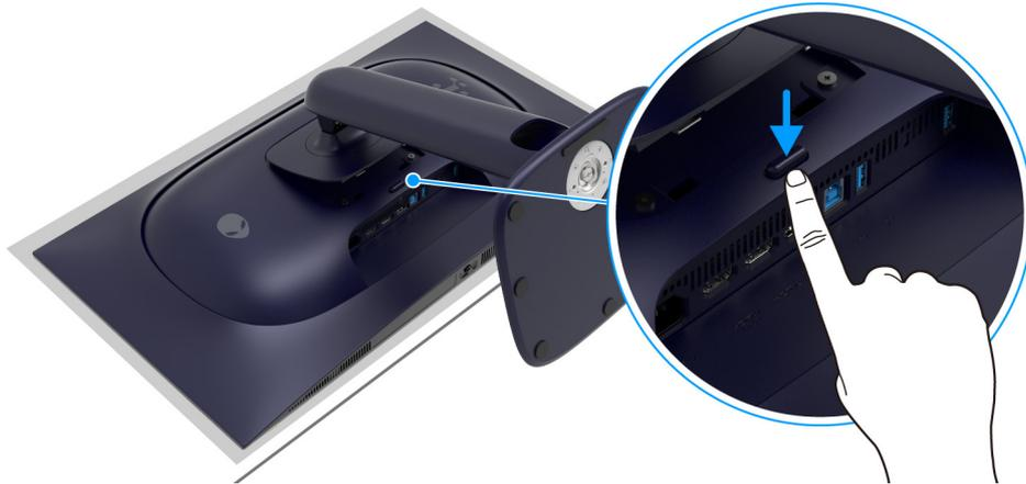
**Abbildung 30. Halten Sie die Ständer Entriegelungstaste gedrückt**
