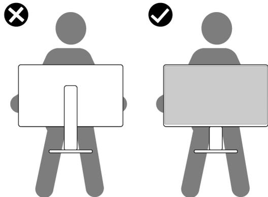
**Abbildung 12. Richtiges Anheben des Monitors**
