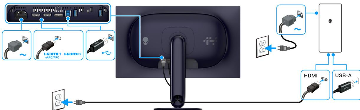
Abbildung 28. HDMI Verbindung
