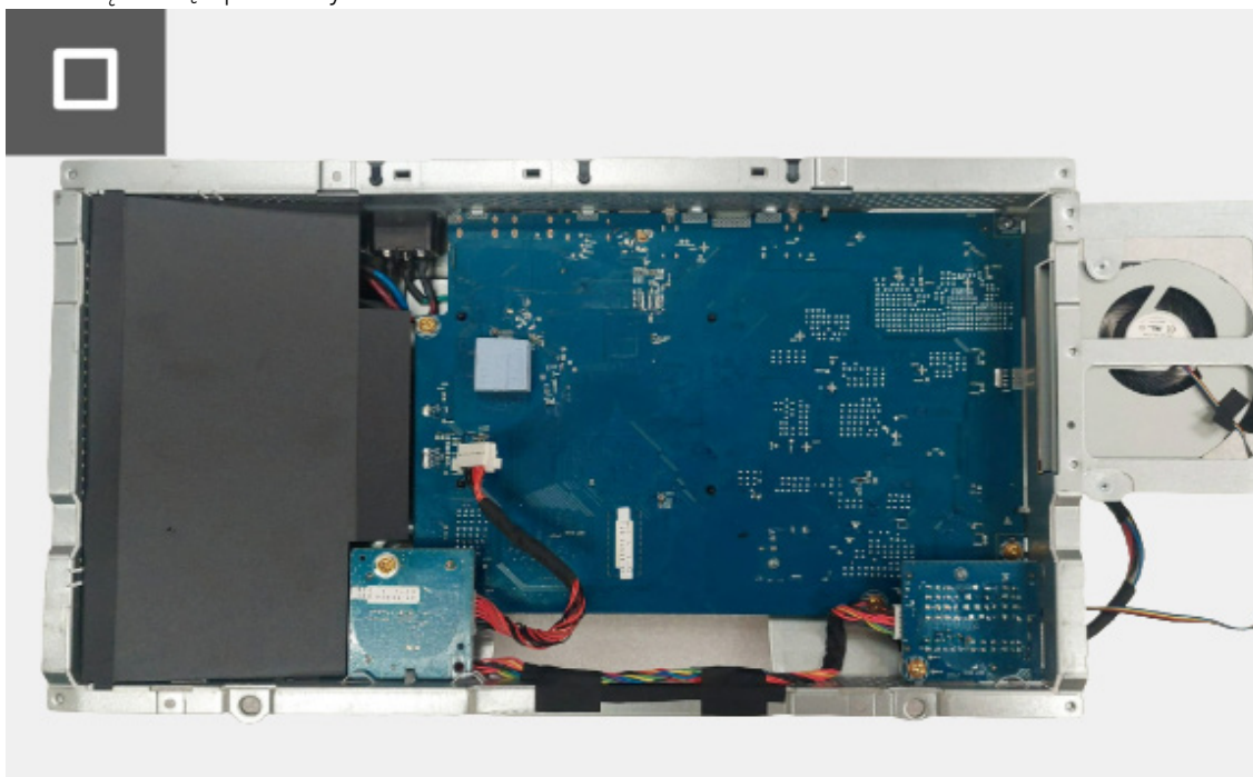
Rysunek 13. Zdejmowanie metalowej osłony
