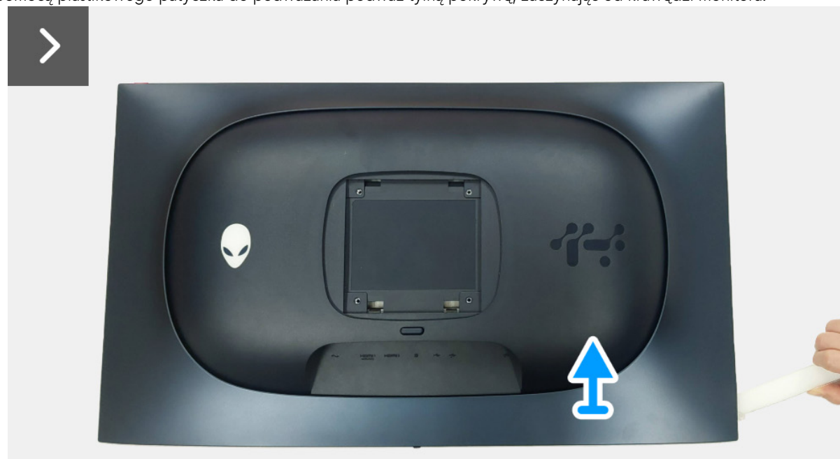
Rysunek 5. Demontaż tylnej pokrywy
