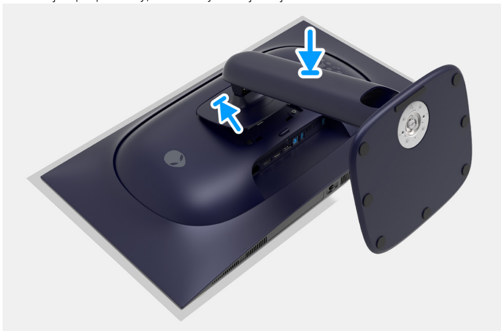
Rysunek 3. Montaż stojaka
