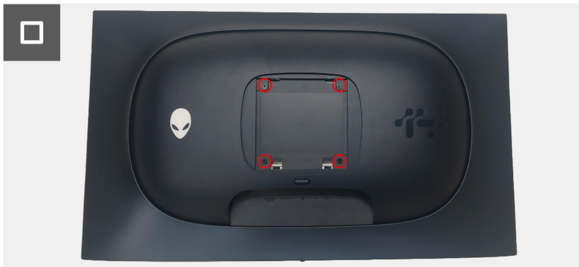
Rysunek 9. Montaż tylnej pokrywy
