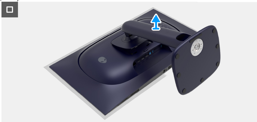
Rysunek 2. Demontaż stojaka
