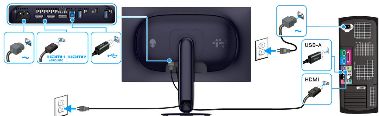
Figura 9. Conexión del cable HDMI
