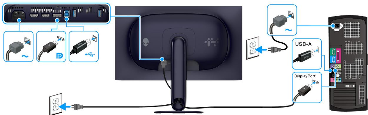
Figura 8. Conexión del cable DisplayPort
