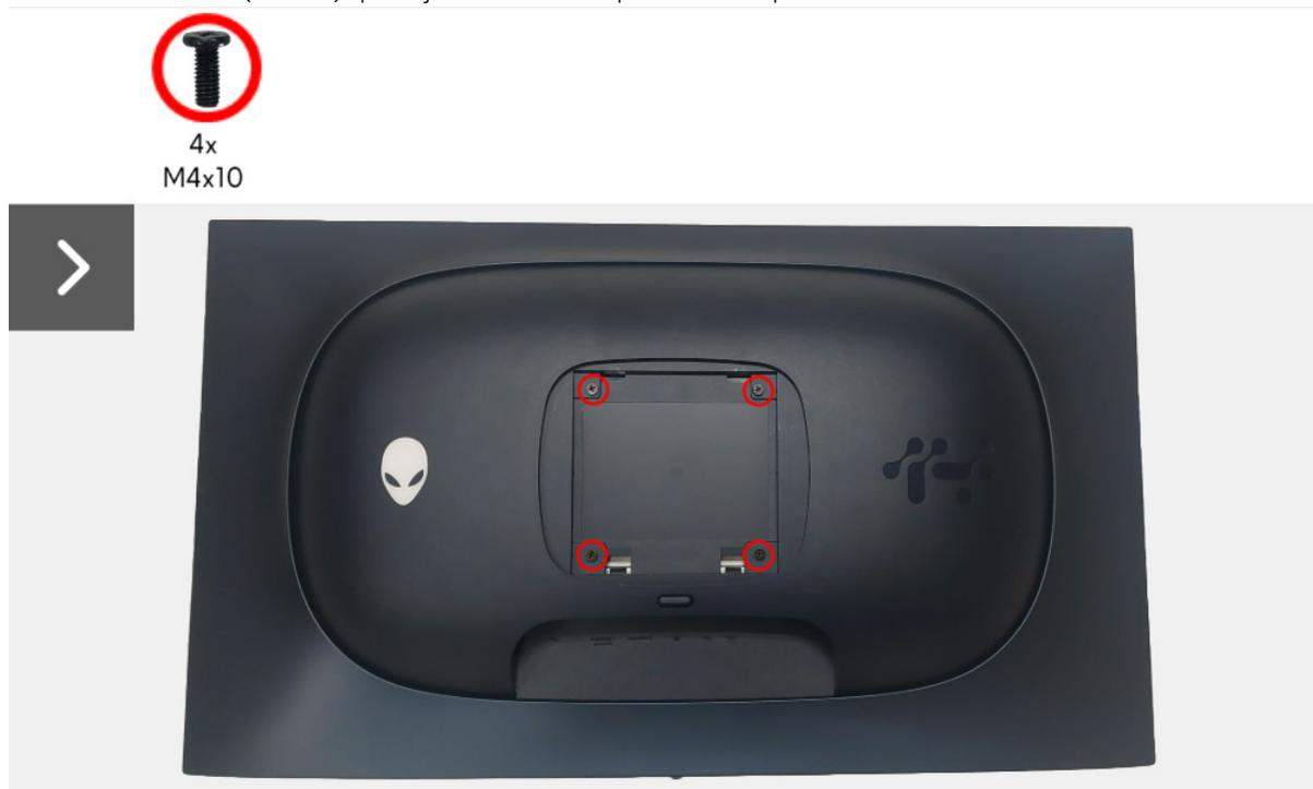
**Figura 13. Retirar la cubierta posterior**
