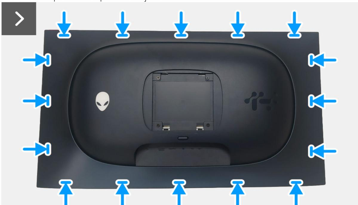
**Figura 17. Instalar la cubierta posterior**
