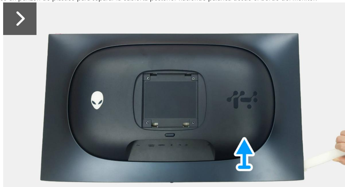
**Figura 14. Retirar la cubierta posterior**
