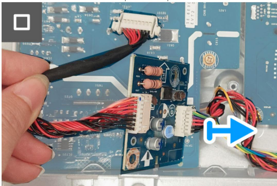
**Figura 28. Retirar la placa de interruptores**
