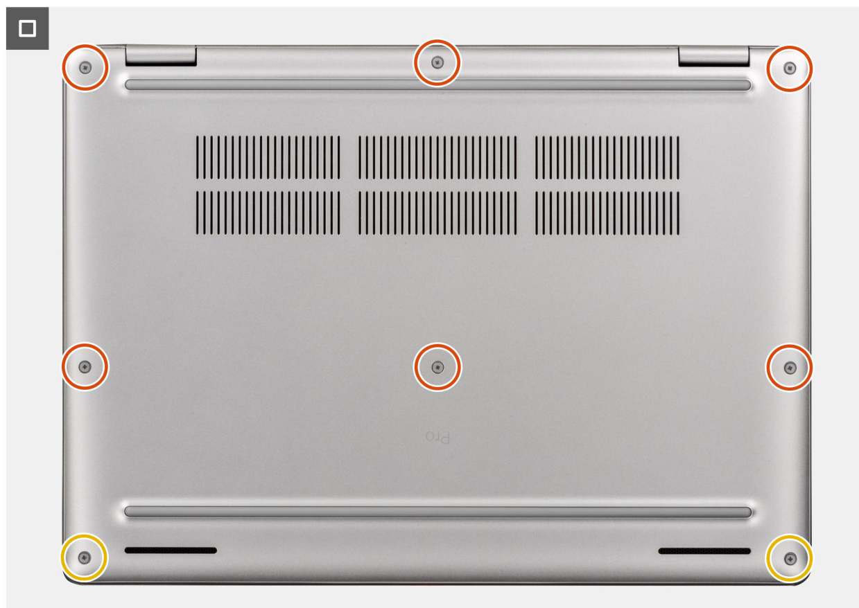
Ilustración 26. Instalación de la cubierta de la base
