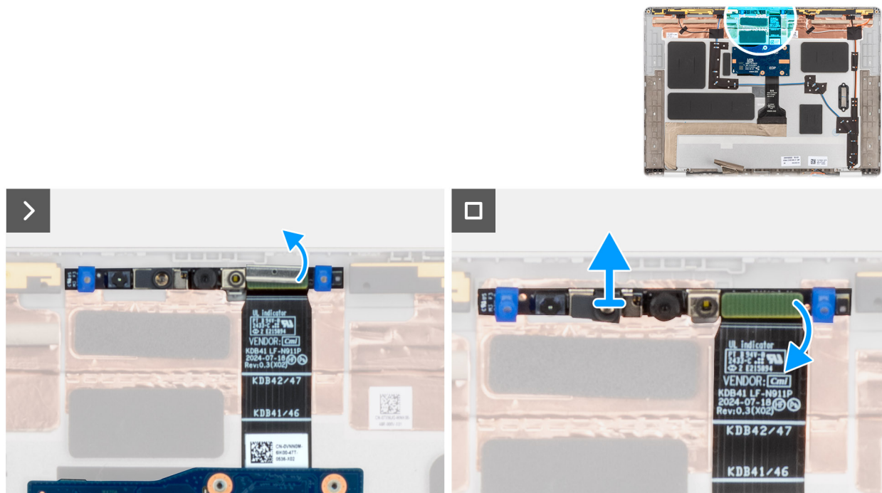
Ilustración 87. Extracción de la cámara MIPI
