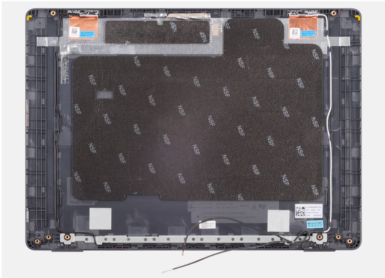
Abbildung 96. Entfernen der Baugruppe der hinteren Bildschirmabdeckung
