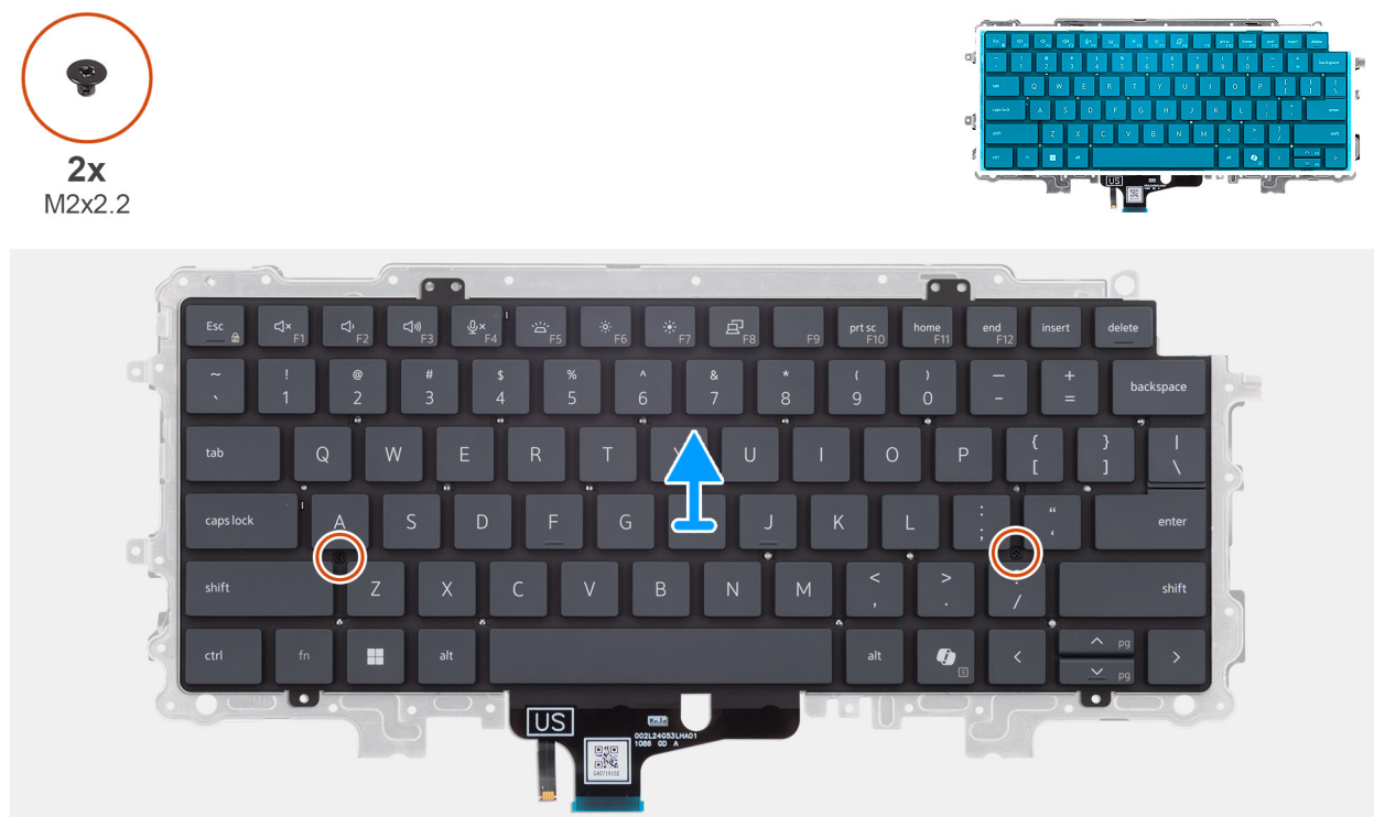
Abbildung 66. Entfernen der Tastaturstützplatte
