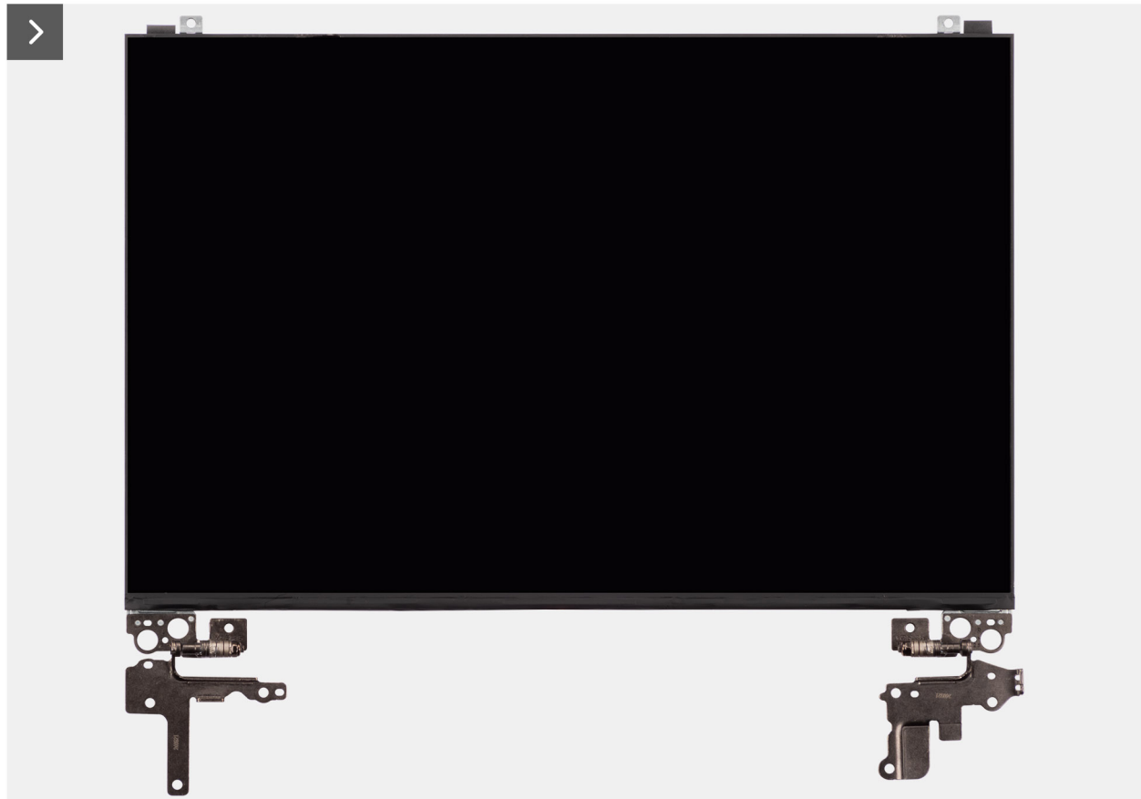
Abbildung 88. Installieren der Bildschirmbaugruppe
