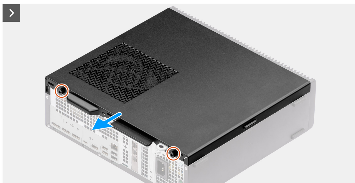
Figura 9. Rimozione del coperchio laterale
