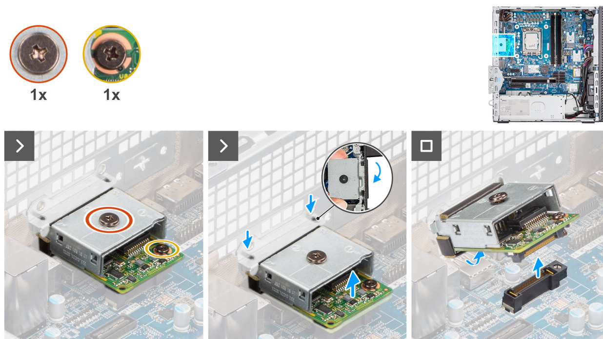
Figura 70. Rimozione del modulo LAN opzionale
