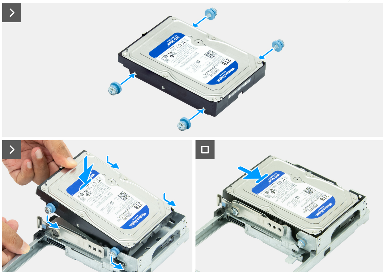
Figura 30. Installazione del disco rigido
