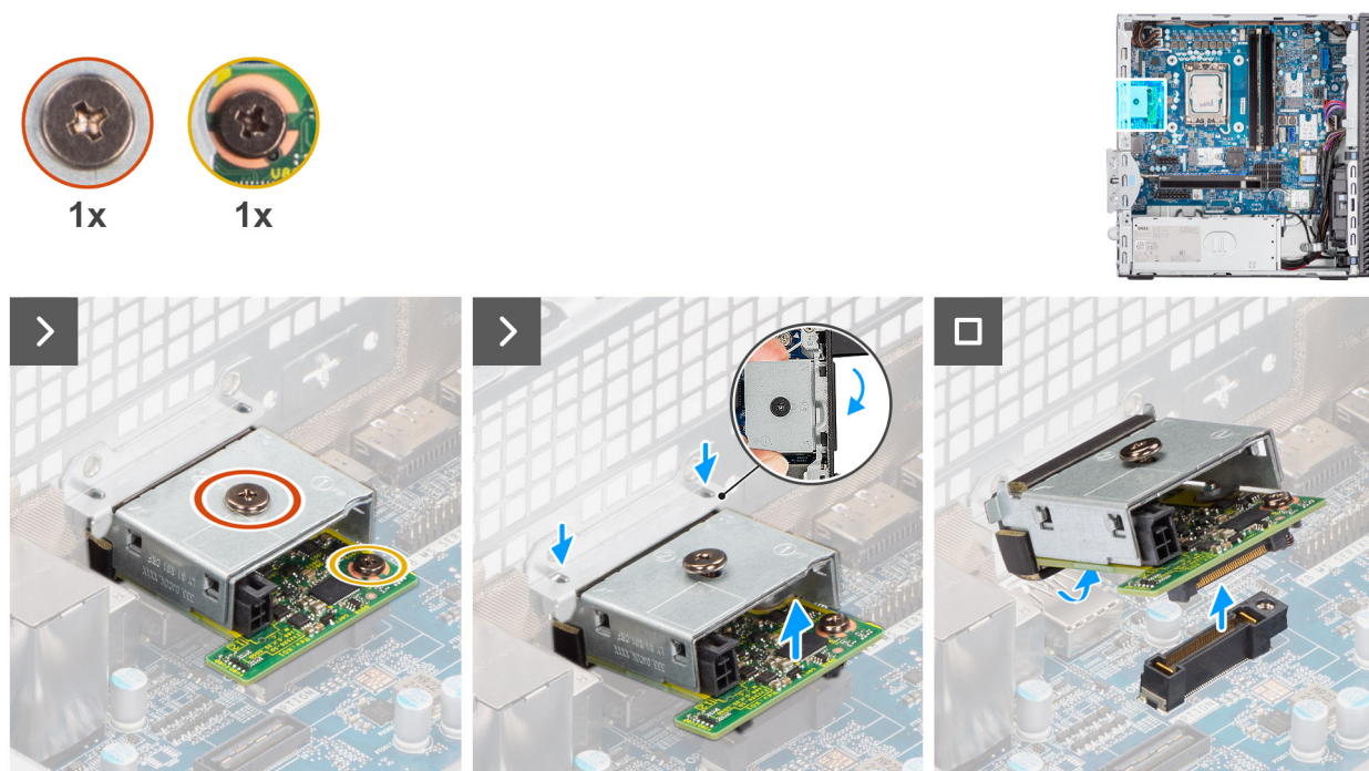
Figura 67. Rimozione del modulo Thunderbolt opzionale
