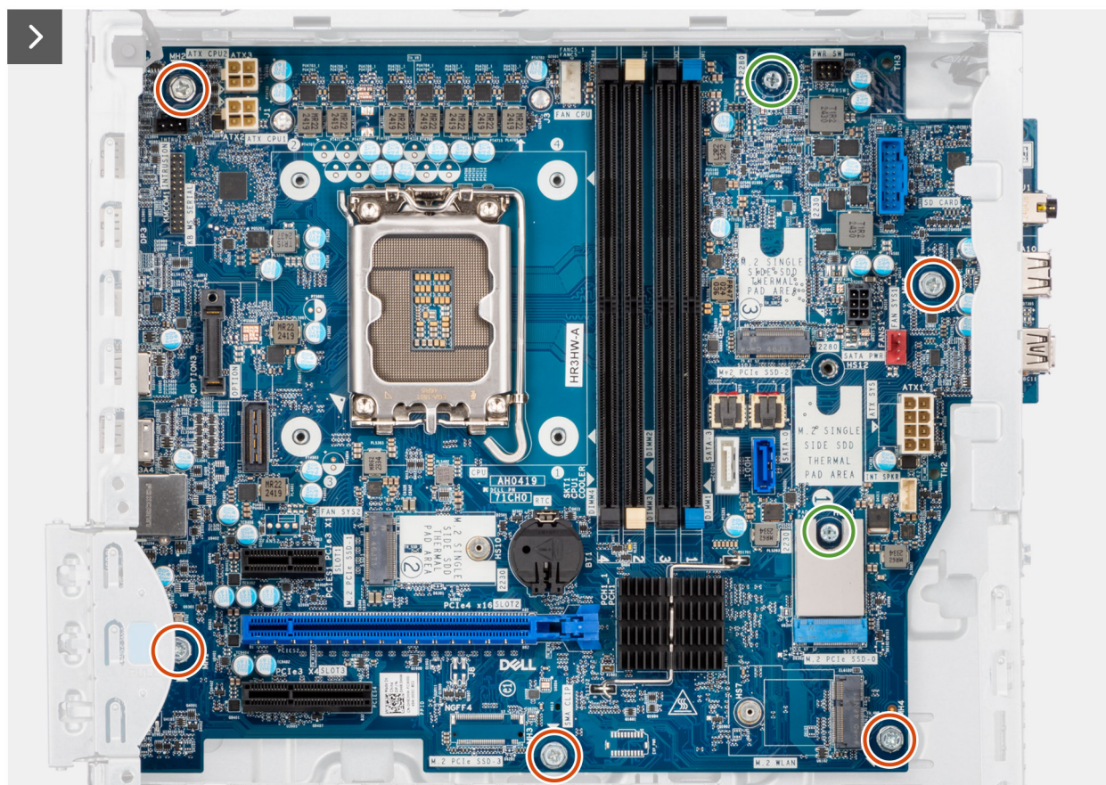
Figura 85. Rimozione della scheda di sistema
