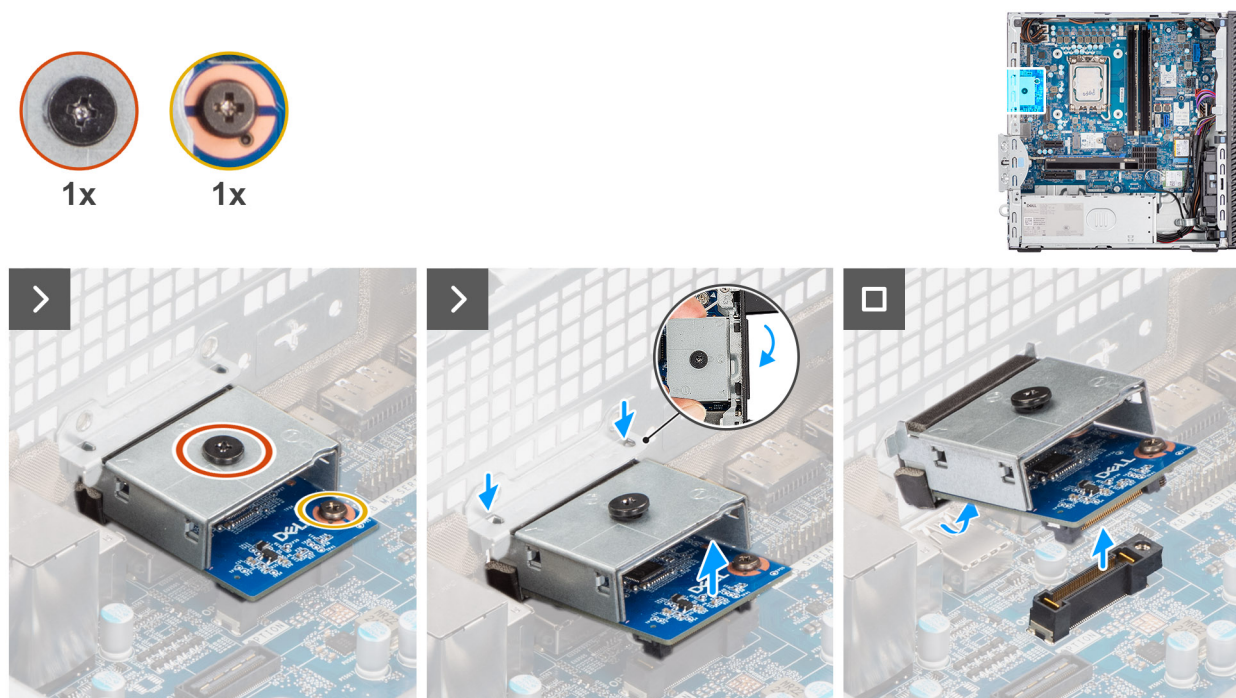
Figura 73. Rimozione del modulo HDMI opzionale
