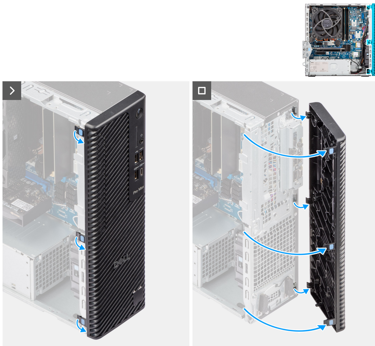
Figura 15. Rimozione del coperchio anteriore
