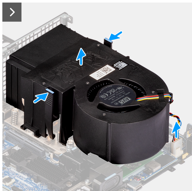
Afbeelding 15. De systeemventilator verwijderen
