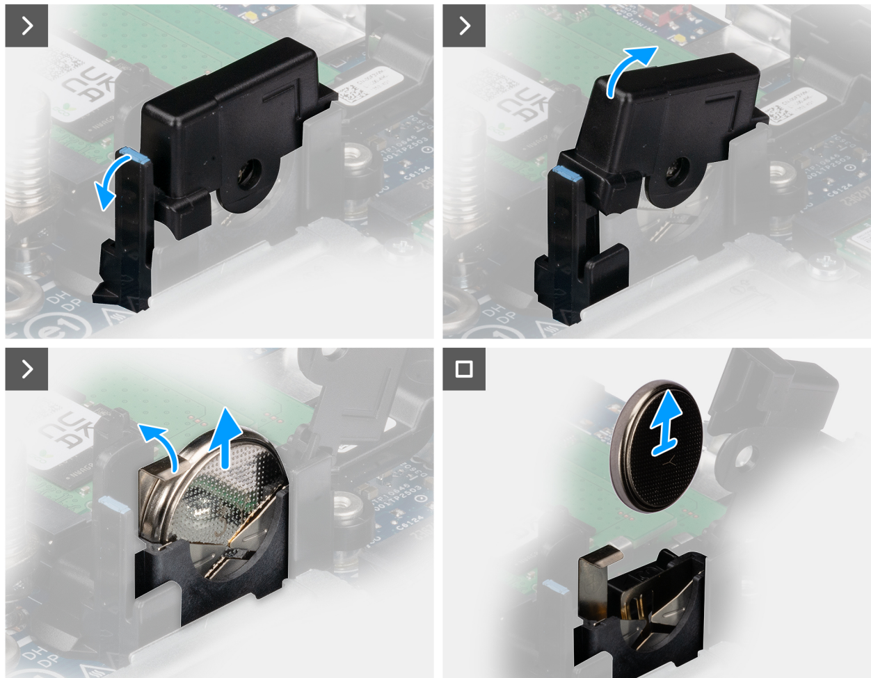
Afbeelding 7. De knoopcelbatterij verwijderen
