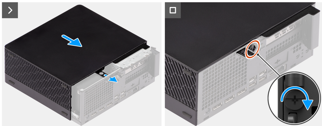
Afbeelding 6. De zijplaat plaatsen
