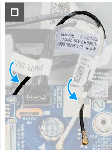
Abbildung 61. Einbauen der internen Antenne – Position 2
