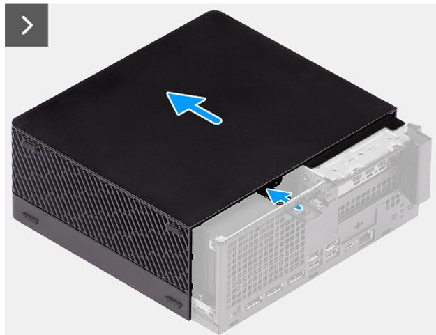
Abbildung 3. Entfernen der Seitenabdeckung
