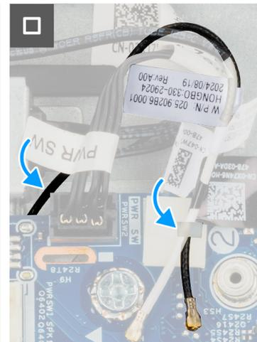
Figure 61. Installation de l'antenne interne (emplacement 2)
