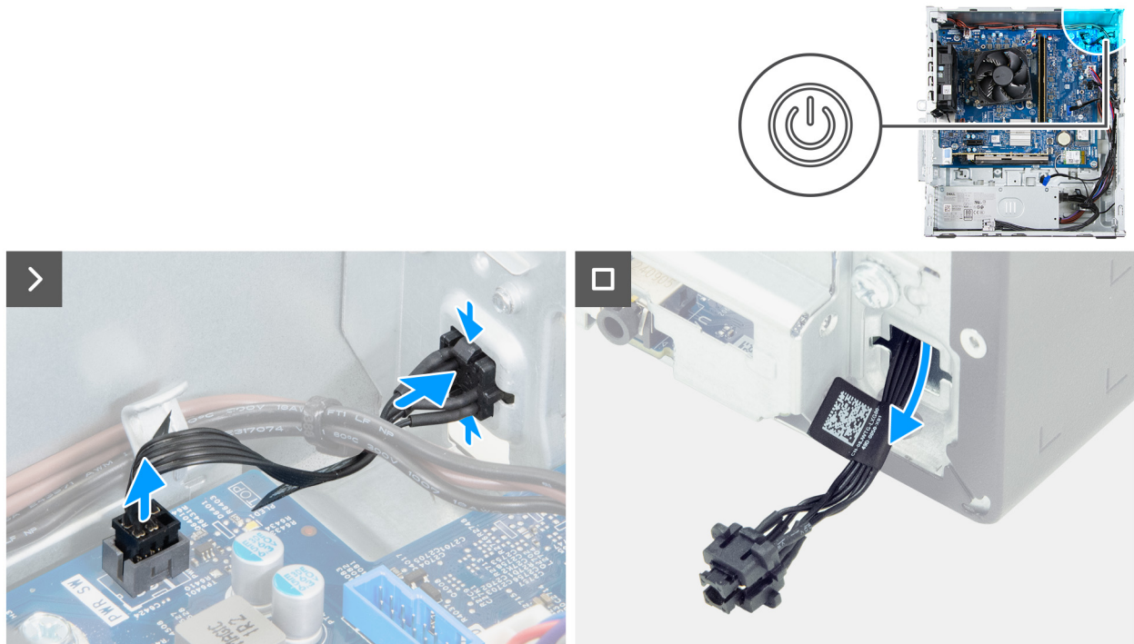
Ilustración 34. Extracción del botón de encendido
