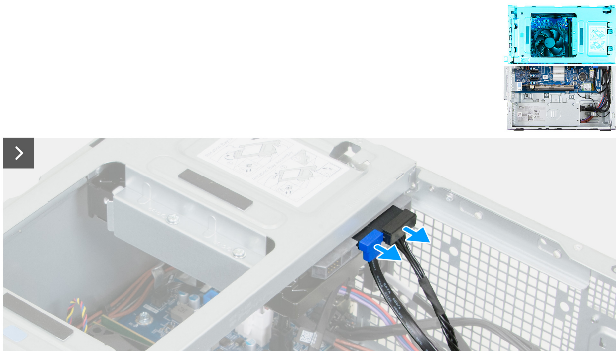
Ilustración 28. Extracción de la bahía de discos
