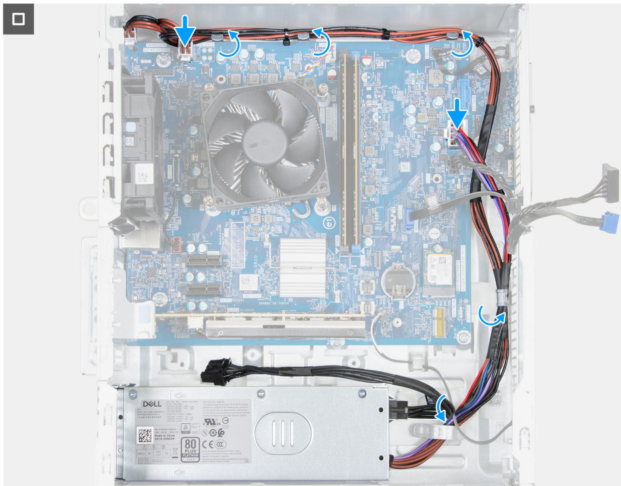
Ilustración 48. Instalación de la fuente de alimentación
