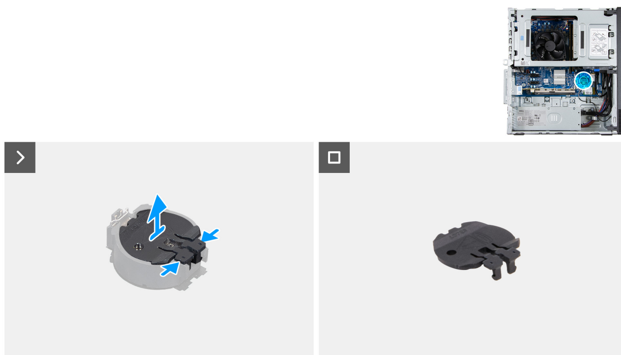
Ilustración 14. Extracción de la cubierta de la batería de tipo botón
