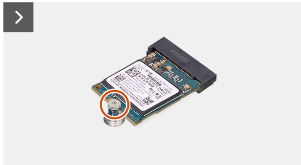
Ilustración 22. Extracción de la unidad de estado sólido M.2 2230
