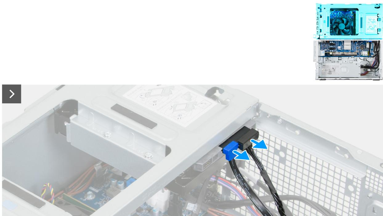
Figura 28. Rimozione del drive bay
