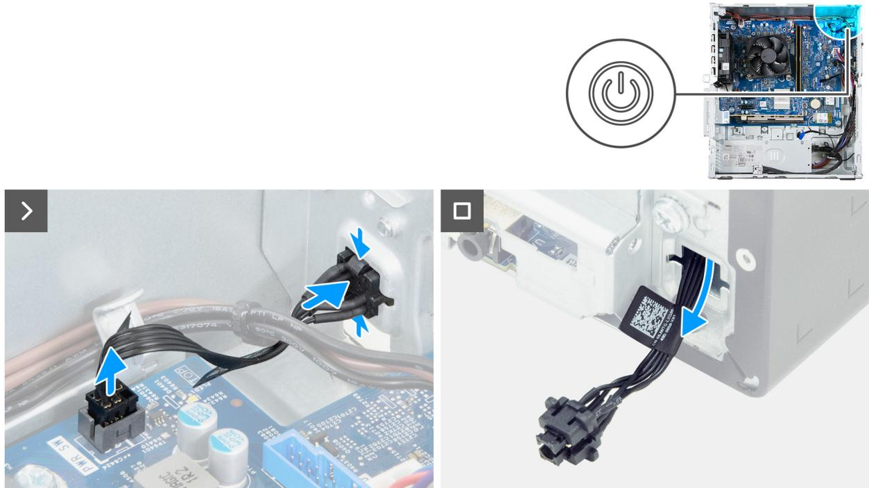
Figura 34. Rimozione del pulsante di accensione
