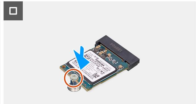
Figura 23. Installazione dell'unità SSD M.2 2230
