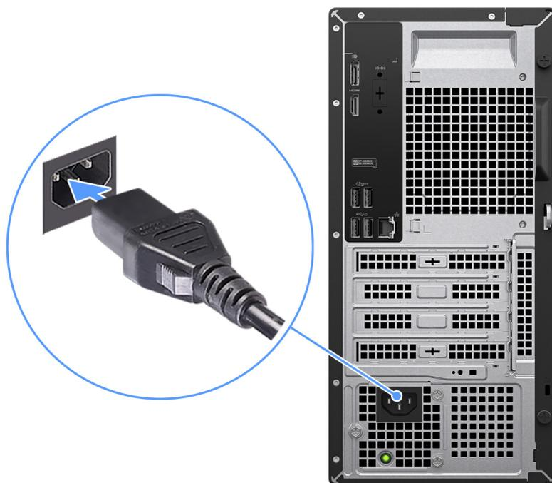
**Figura 7. Collegamento del cavo di alimentazione**
