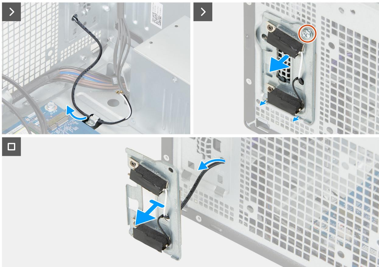
Figura 43. Rimozione dei moduli dell'antenna
