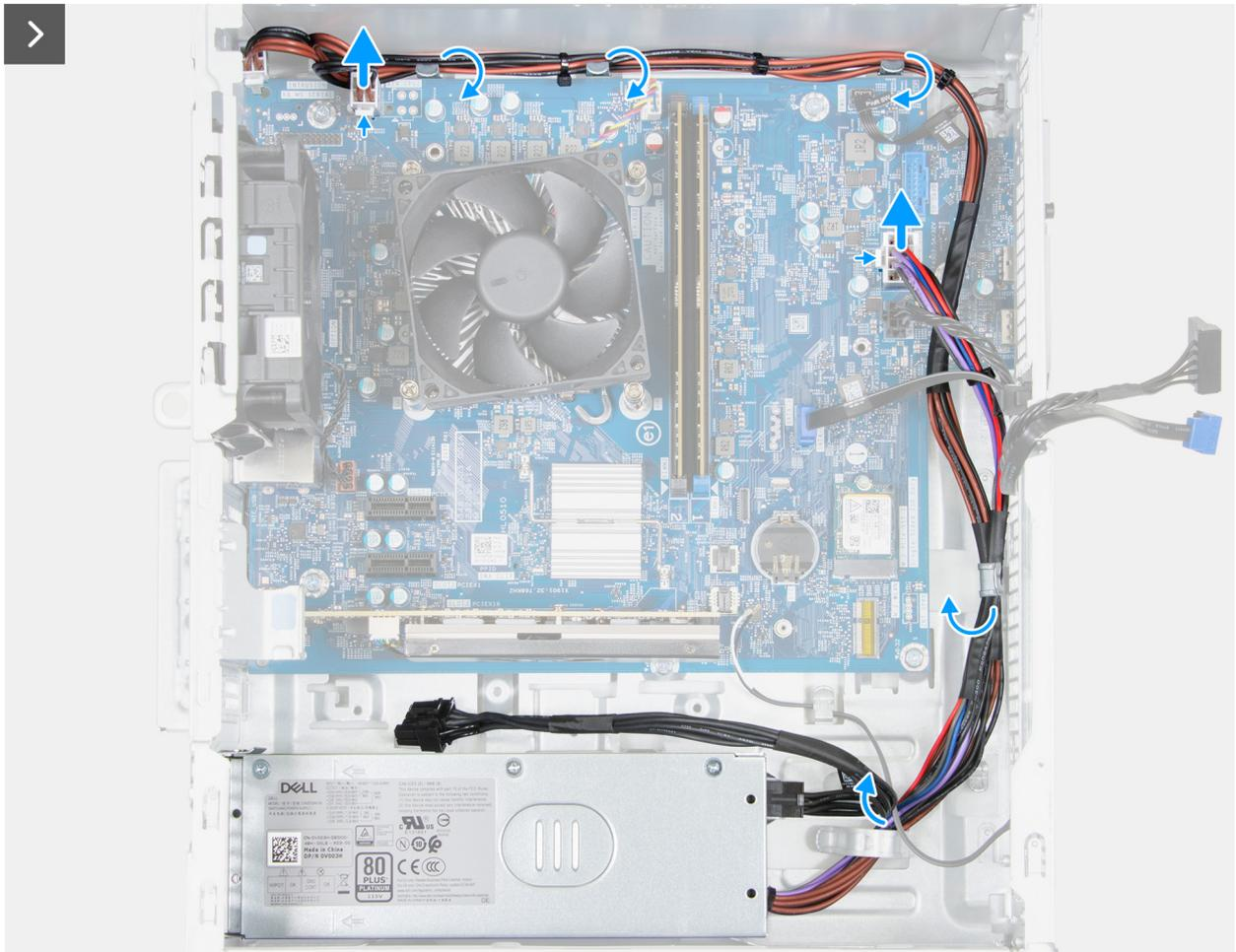
Figura 45. Rimozione dell'unità di alimentazione
