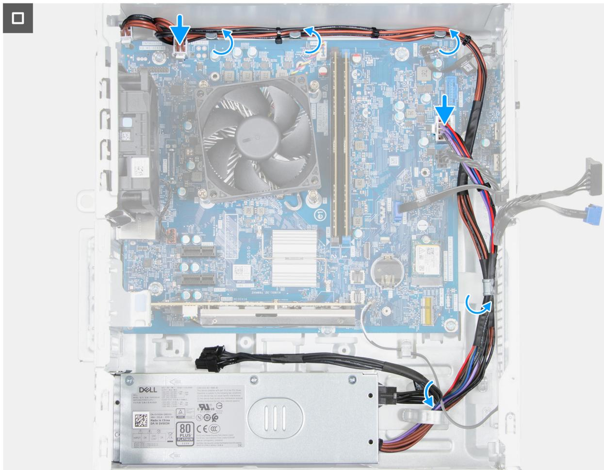
**Figura 48. Installazione dell'unità di alimentazione**
