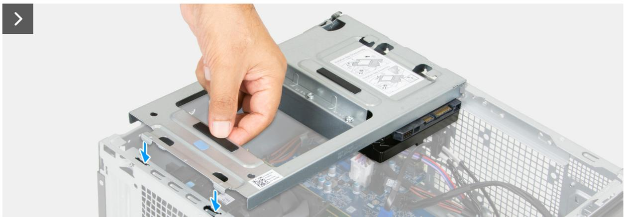
Figura 30. Installazione del drive bay
