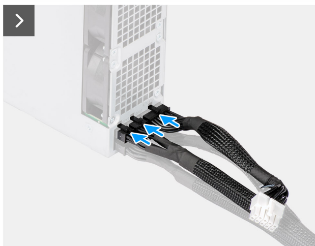
Obrázek 55. Montáž 1500W napájecího zdroje
