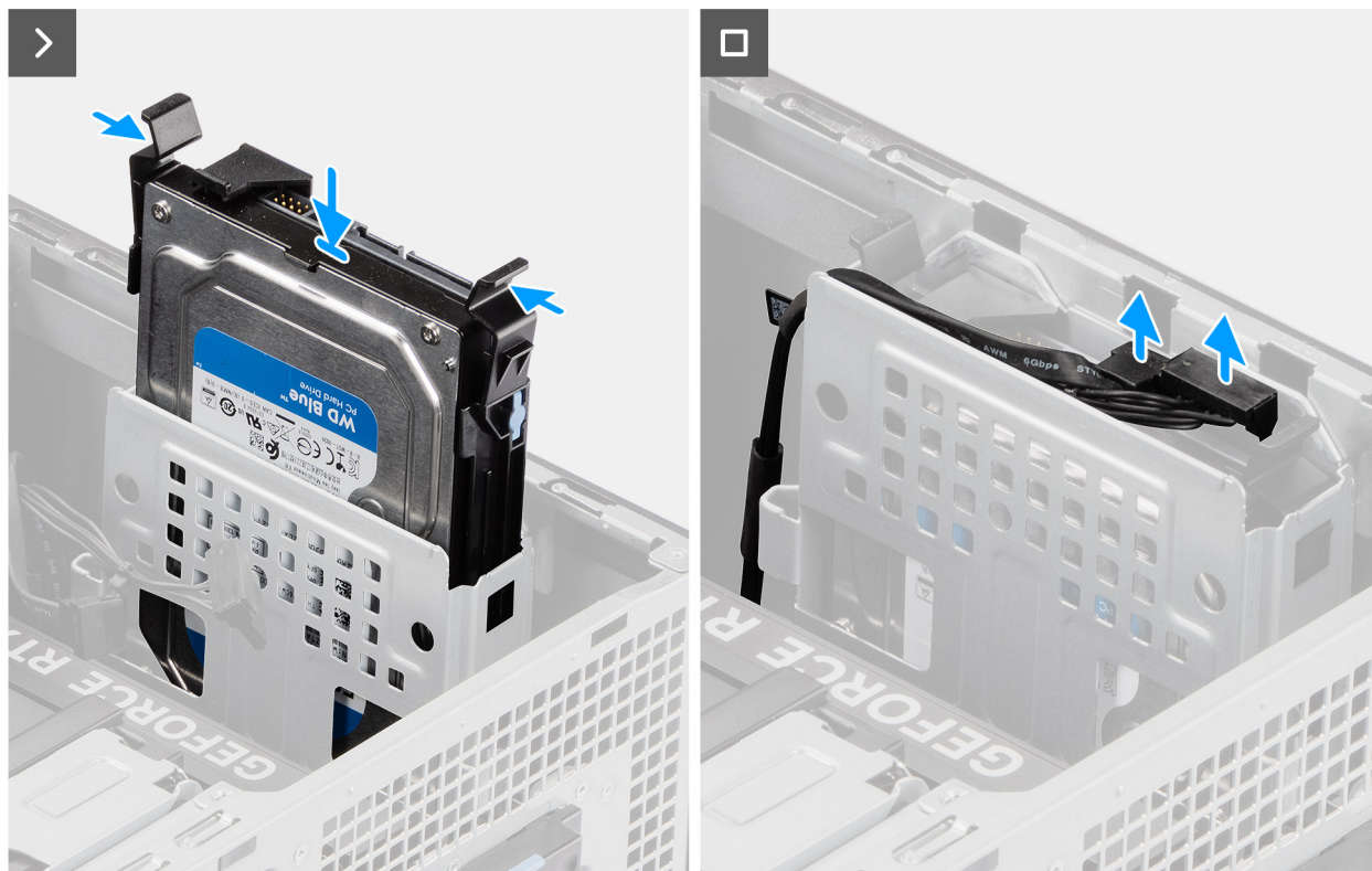
Obrázek 29. Montáž sestavy 3,5palcového pevného disku (zásuvka 2)
