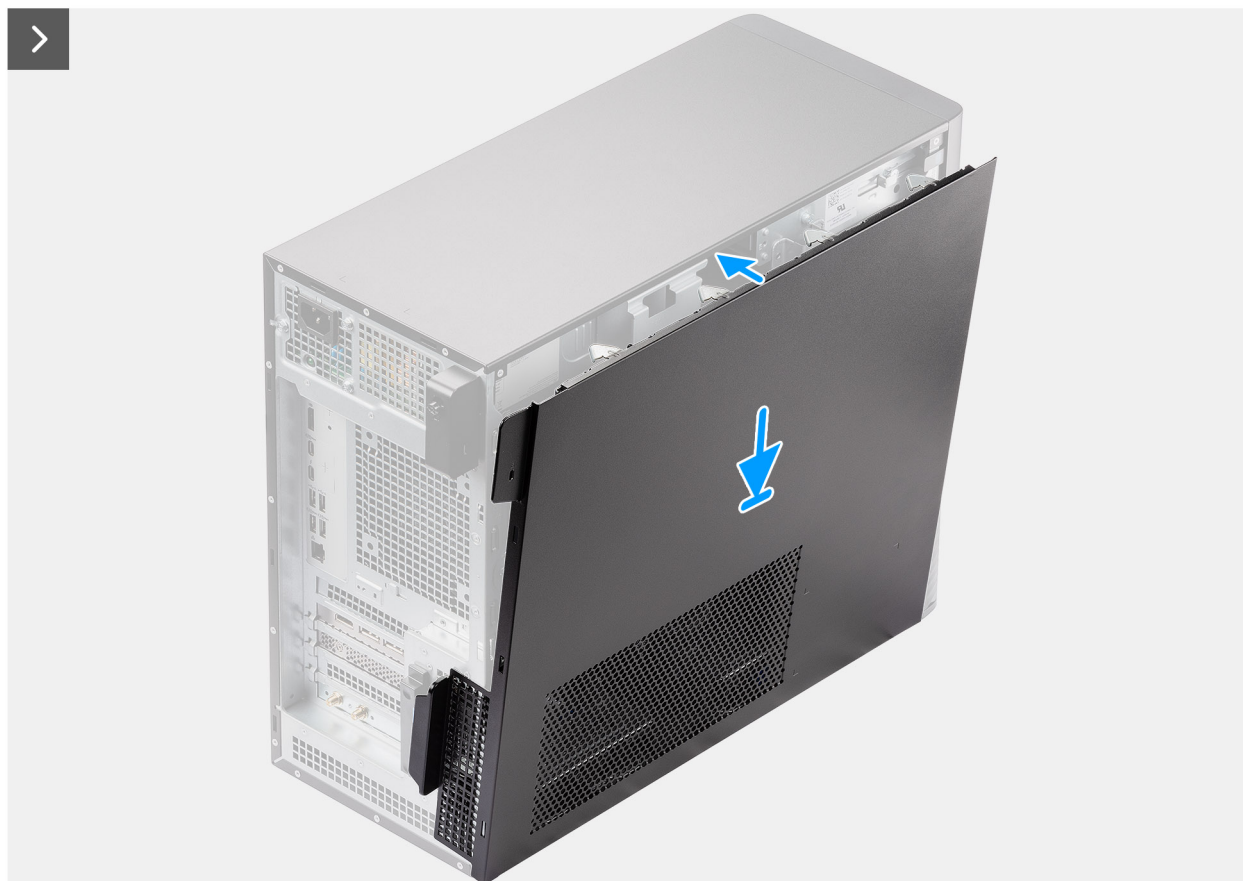
Obrázek 11. Montáž bočního krytu
