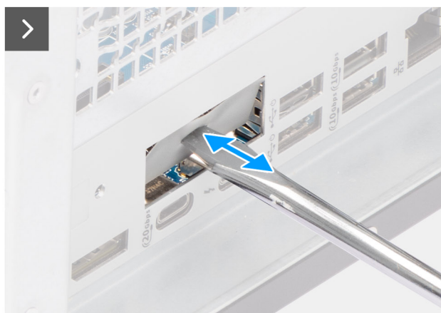
Obrázek 86. Montáž volitelného modulu VGA
