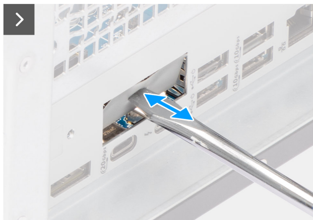
Obrázek 83. Montáž volitelného modulu USB
