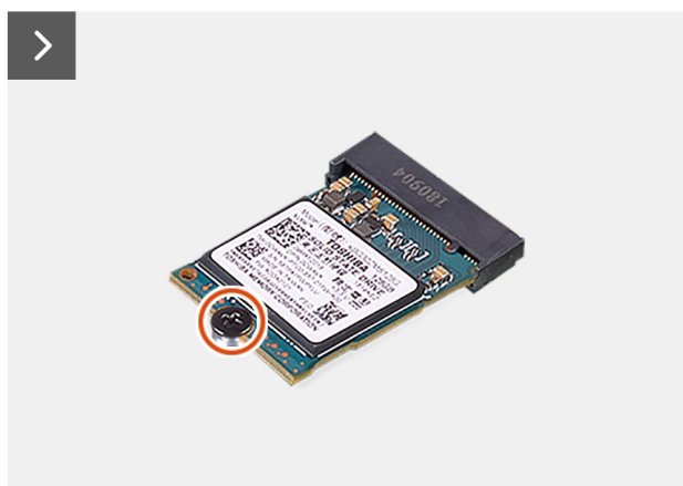
Obrázek 31. Demontáž disku SSD M.2 2230 PCIe
