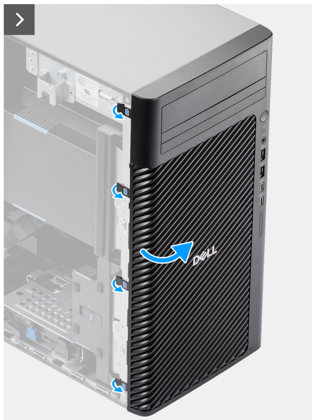
Obrázek 17. Demontáž čelního krytu
