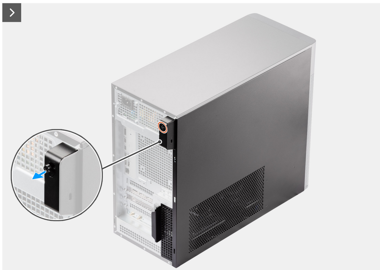
Obrázek 9. Demontáž bočního krytu
