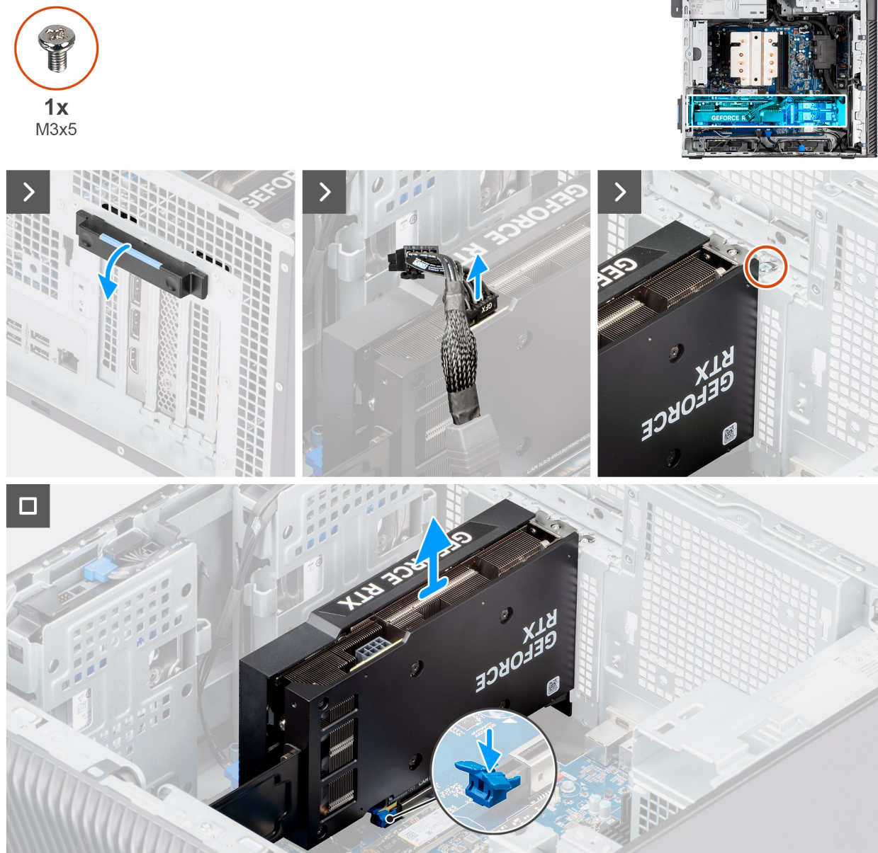
Obrázek 39. Demontáž napájené grafické karty
