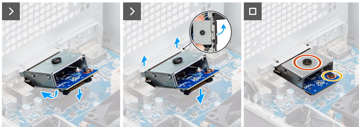
Obrázek 87. Montáž volitelného modulu VGA
