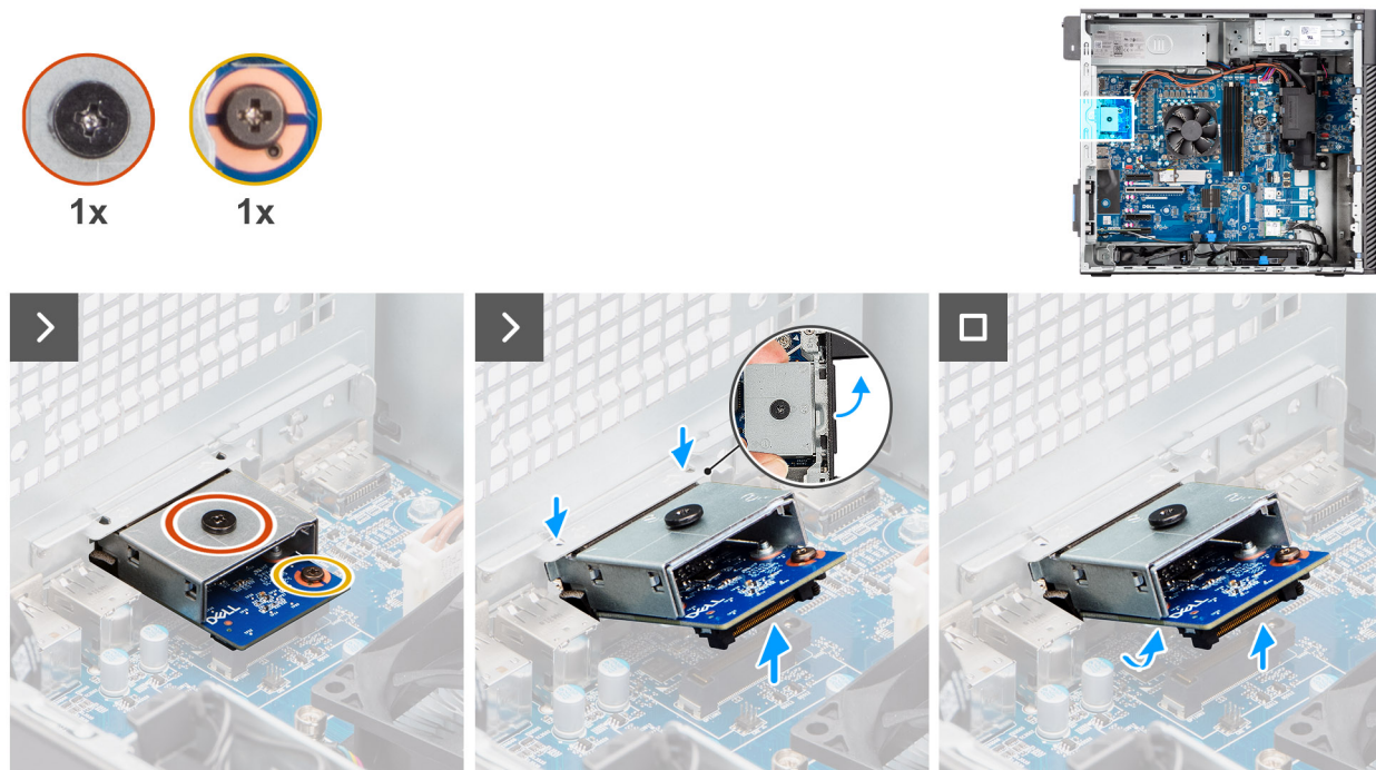
Obrázek 85. Demontáž volitelného modulu VGA
