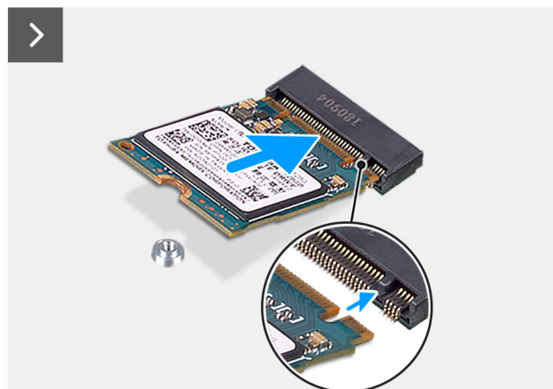
Obrázek 32. Montáž disku SSD M.2 2230 PCIe
