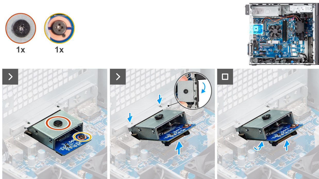
Obrázek 70. Demontáž volitelného modulu HDMI
