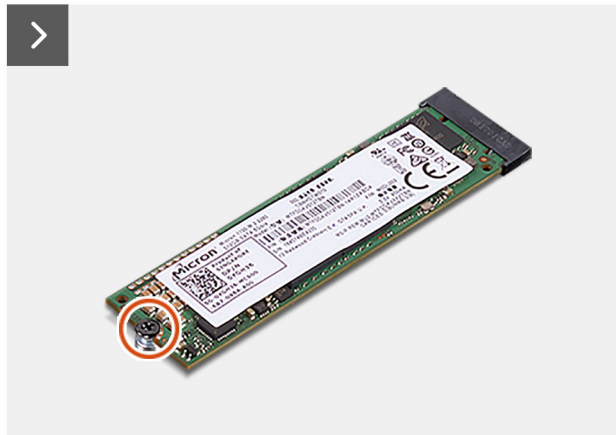
Abbildung 33. Entfernen des M.2 2280-PCIe-SSD-Laufwerks
