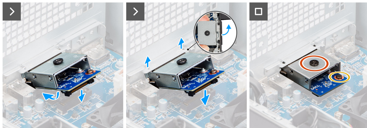
Abbildung 87. Installieren des optionalen VGA-Moduls
