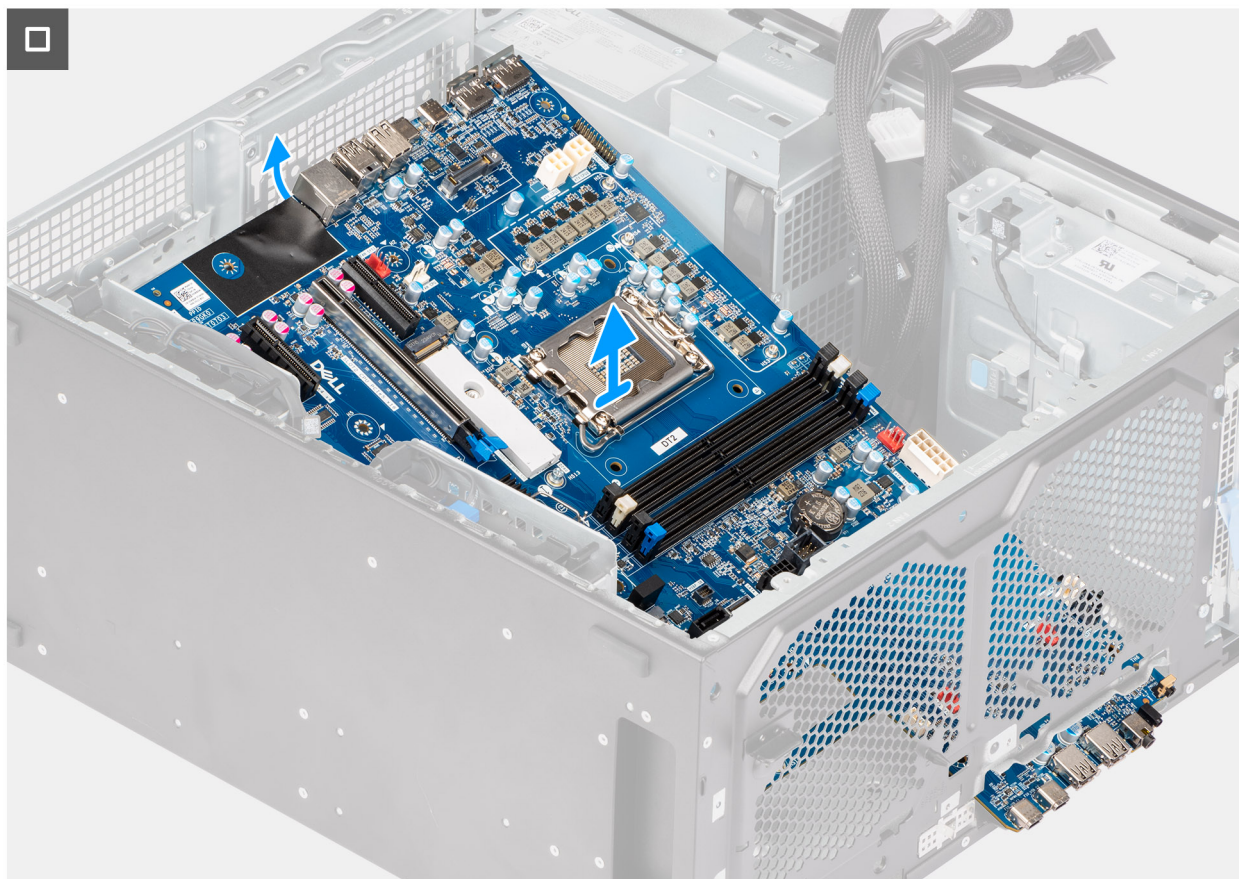
Abbildung 92. Entfernen der Systemplatine
