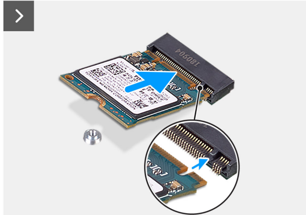
Abbildung 32. Einbauen des M.2 2230-PCIe-SSD-Laufwerks
