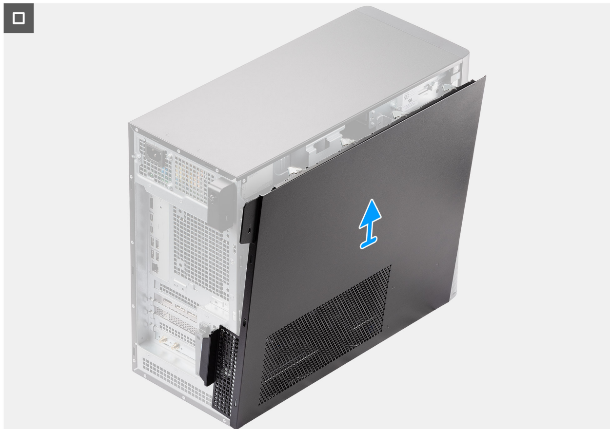
Abbildung 10. Entfernen der Seitenabdeckung
