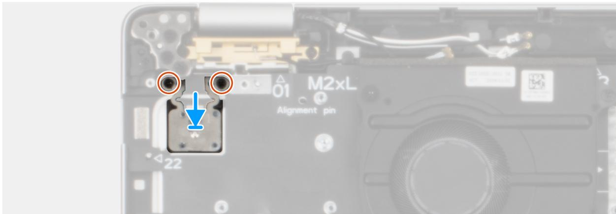
Abbildung 54. Installieren des Netzschalters mit optionalem Fingerabdruck-Lesegerät
