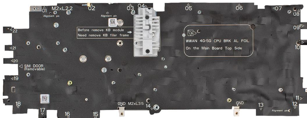
**Abbildung 80. Entfernen der Tastaturhalterung**
