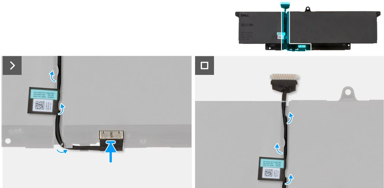
Abbildung 19. Einsetzen des Akkukabels
