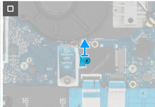
Abbildung 22. Entfernen des M.2-2230-Solid-State-Laufwerks
