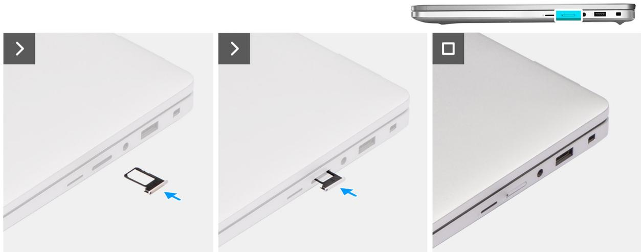
Abbildung 11. Installieren des SIM-Kartenfachs
