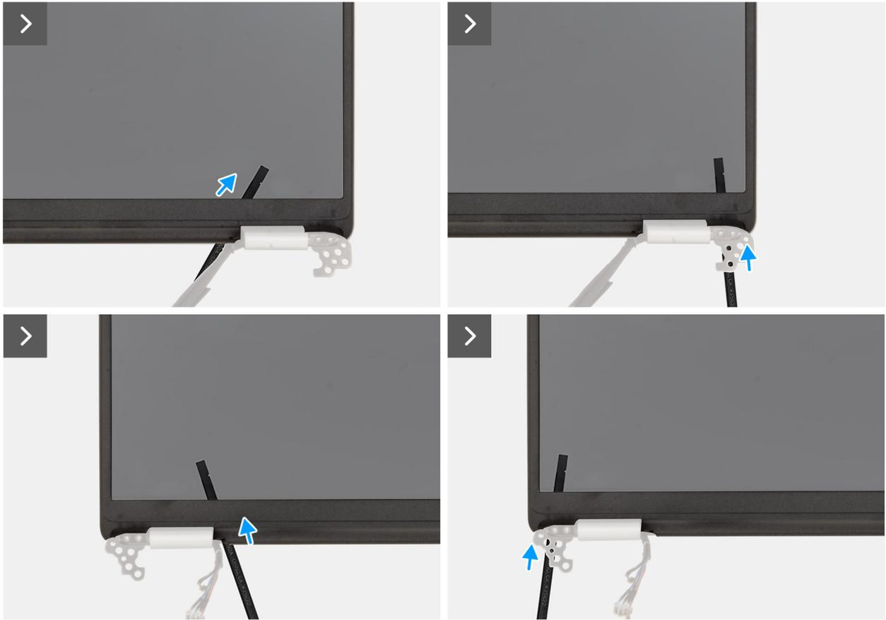
Abbildung 60. Entfernen der Bildschirmblende
