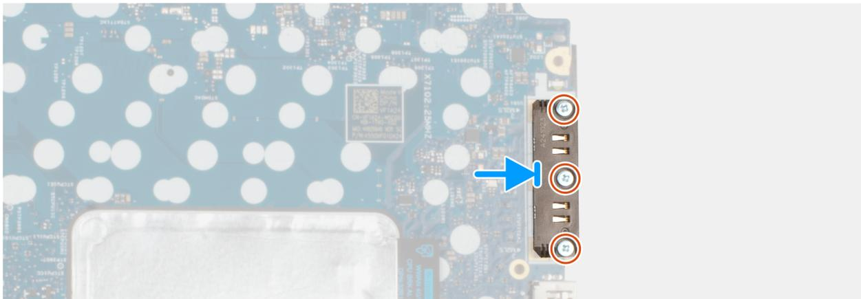
Abbildung 76. Installieren des USB Type-C-Anschlussmoduls
