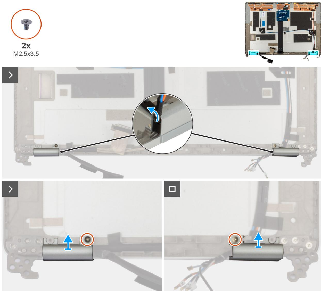
Abbildung 68. Entfernen der Bildschirmscharnierkappen
