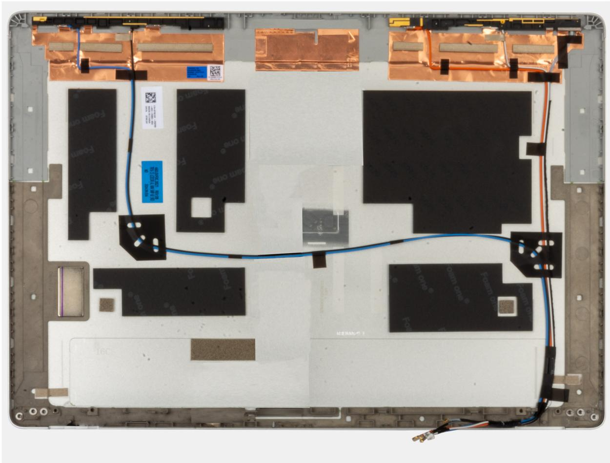
Abbildung 73. Entfernen der hinteren Bildschirmabdeckung
