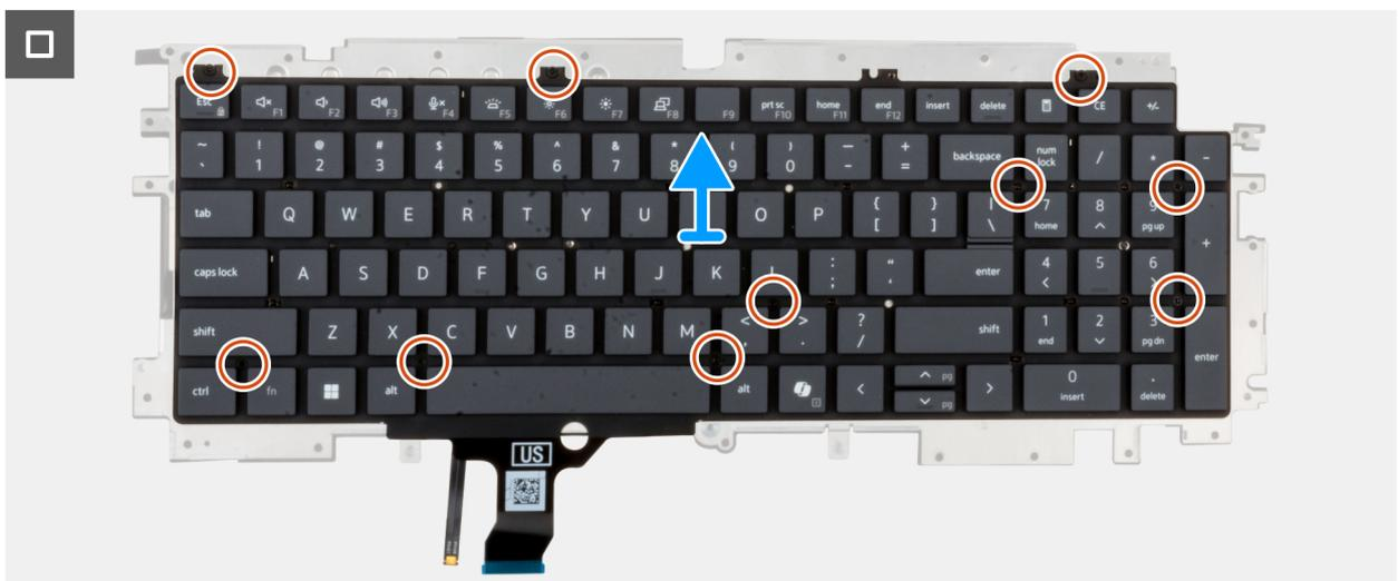
Abbildung 78. Entfernen der Tastatur
