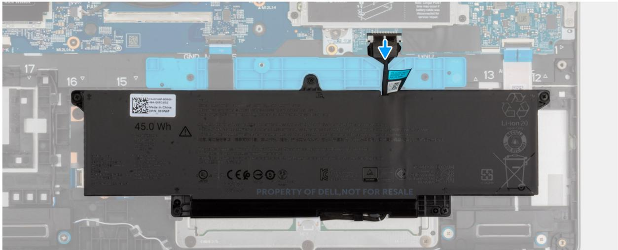
Abbildung 14. Trennen des Akkukabels
