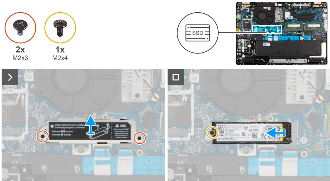
Abbildung 24. Entfernen des M.2-2280-SSD-Laufwerks
