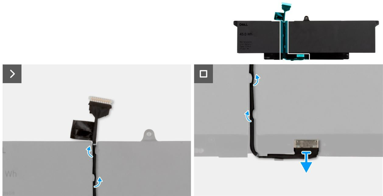
**Abbildung 18. Entfernen des Akkukabels**
