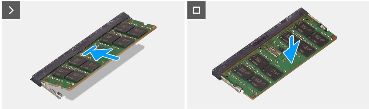
Abbildung 21. Installieren der Speichermodule
