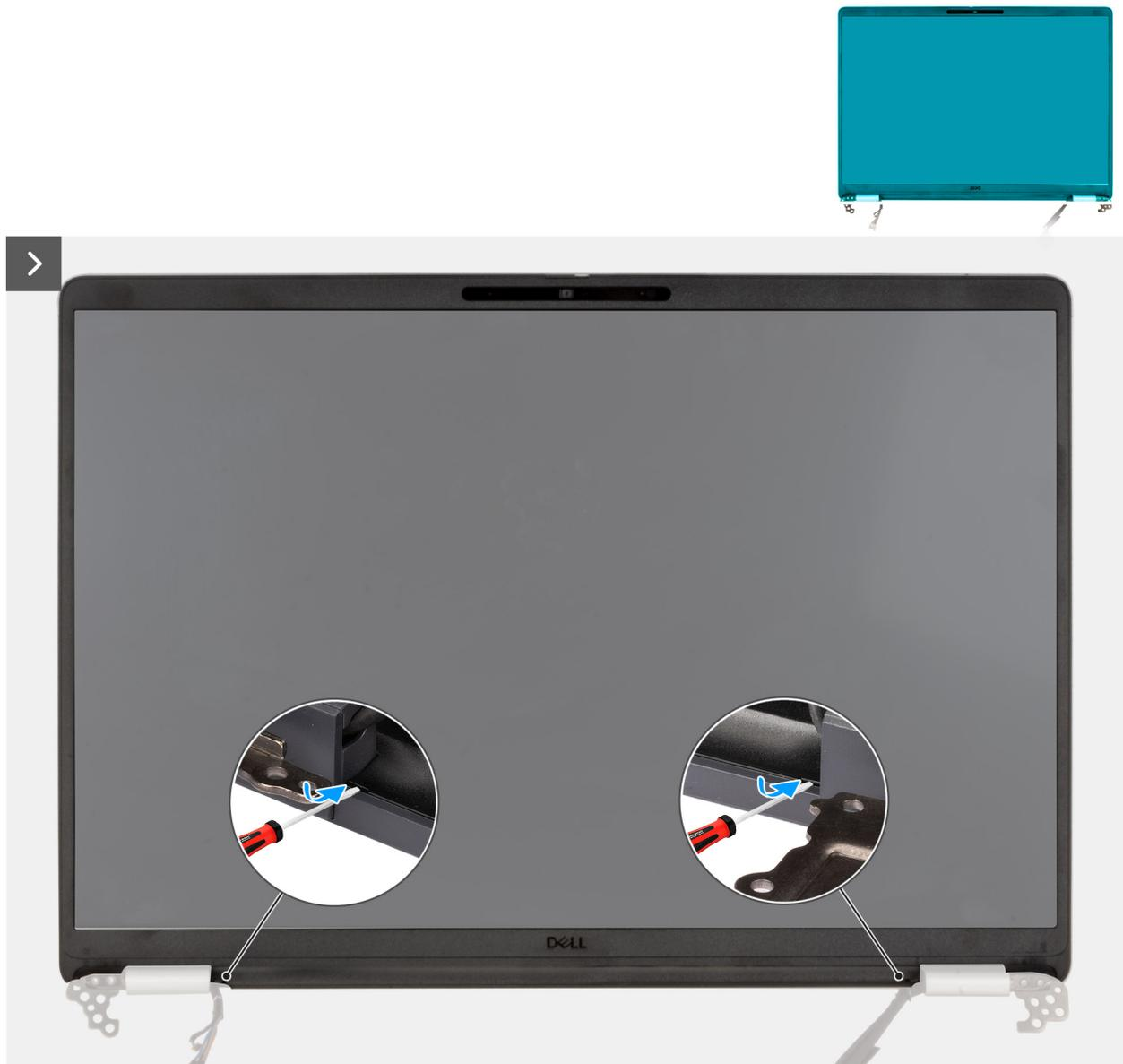
Abbildung 58. Abhebeln der Kunststoffblende
