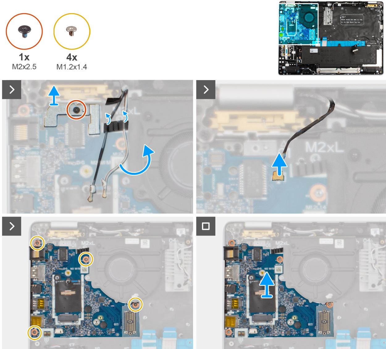
Abbildung 52. Entfernen der E/A-Platine
