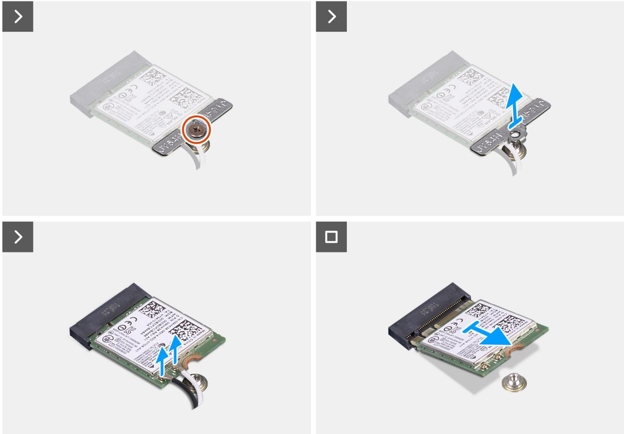
Abbildung 31. Entfernen der WLAN-Karte
