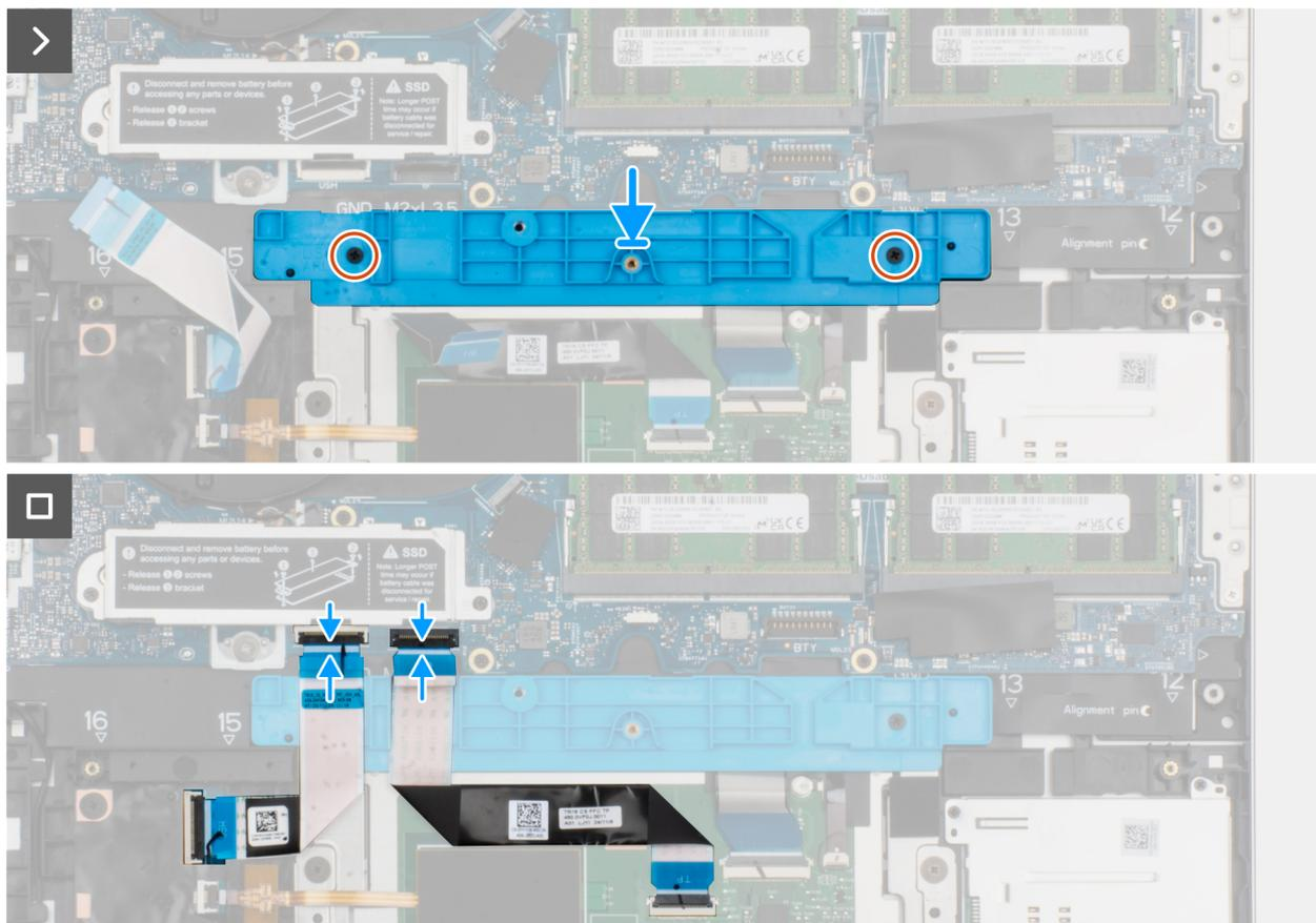
Abbildung 44. Installieren der Akkuhalterung
