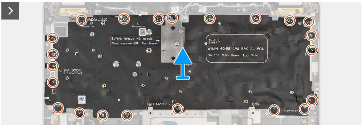
Abbildung 77. Entfernen der Tastatur
