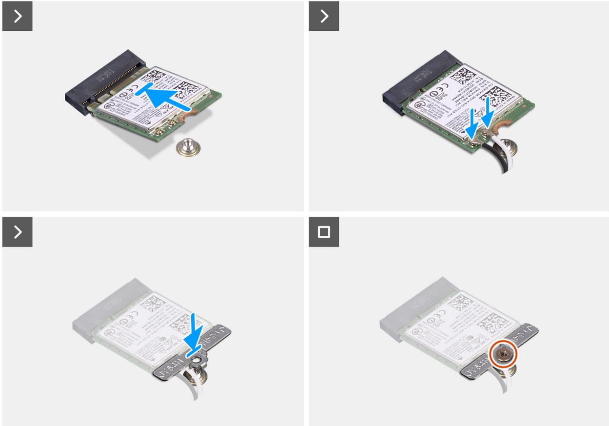
Abbildung 32. Einbauen der WLAN-Karte
