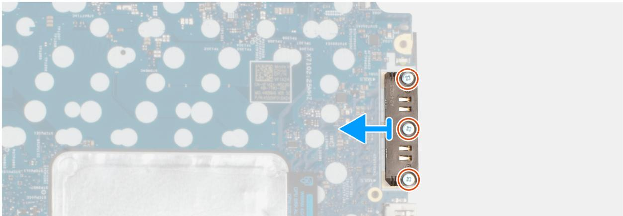
**Abbildung 75. Entfernen des USB Type-C-Anschlussmoduls**
