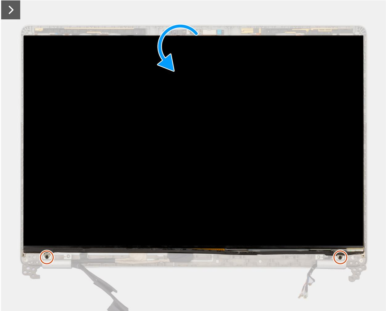
Abbildung 64. Entfernen des Bildschirms
