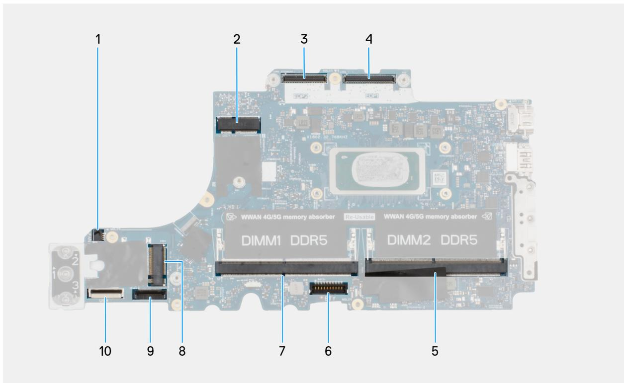
Abbildung 49. Hauptplattenanschluss
