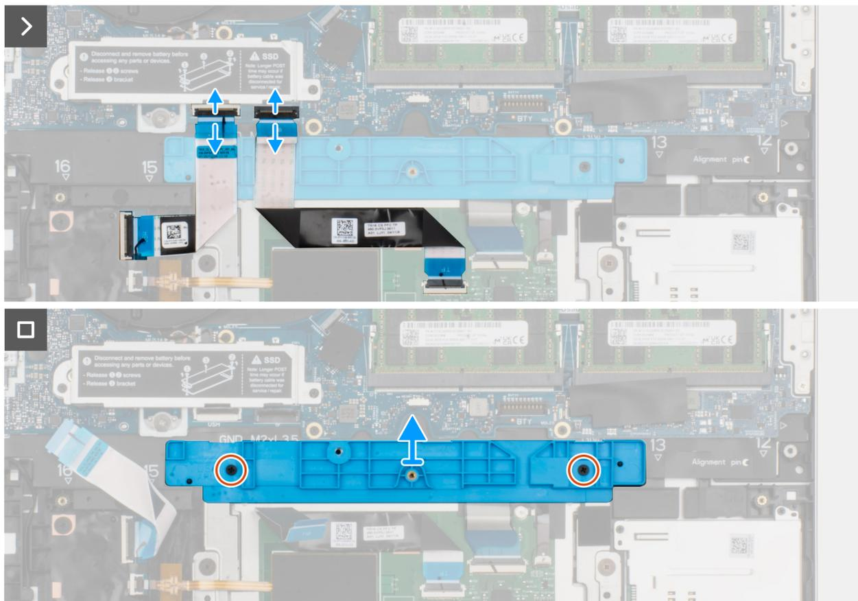
Abbildung 43. Entfernen der Akkuhalterung
