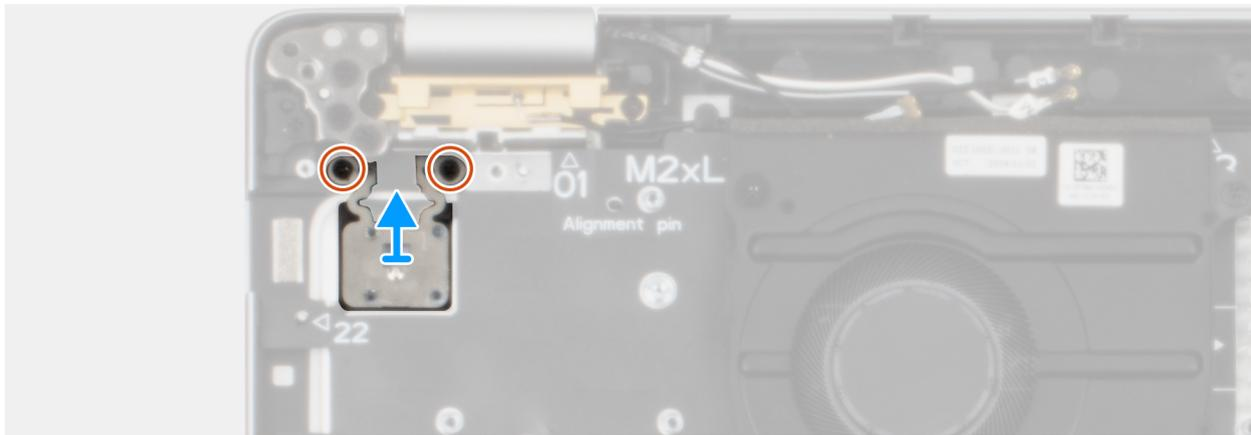
Abbildung 53. Installieren des Netzschalters mit optionalem Fingerabdruck-Lesegerät
