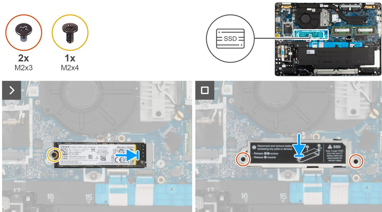
Abbildung 26. Einbauen der M.2230-SSD
