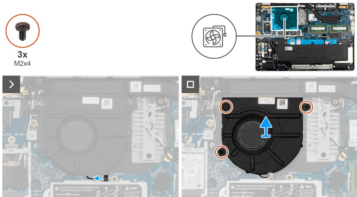
Abbildung 33. Entfernen des Lüfters
