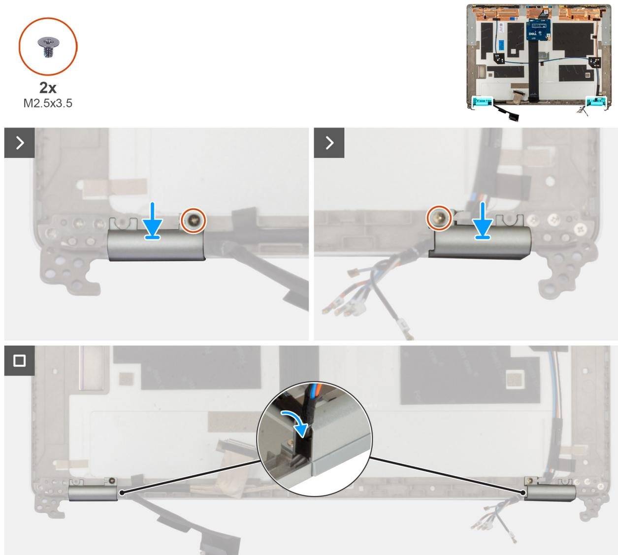
Abbildung 69. Einbauen der Bildschirmscharnierkappe
