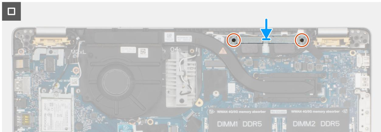
Abbildung 51. Einbauen der Systemplatine
