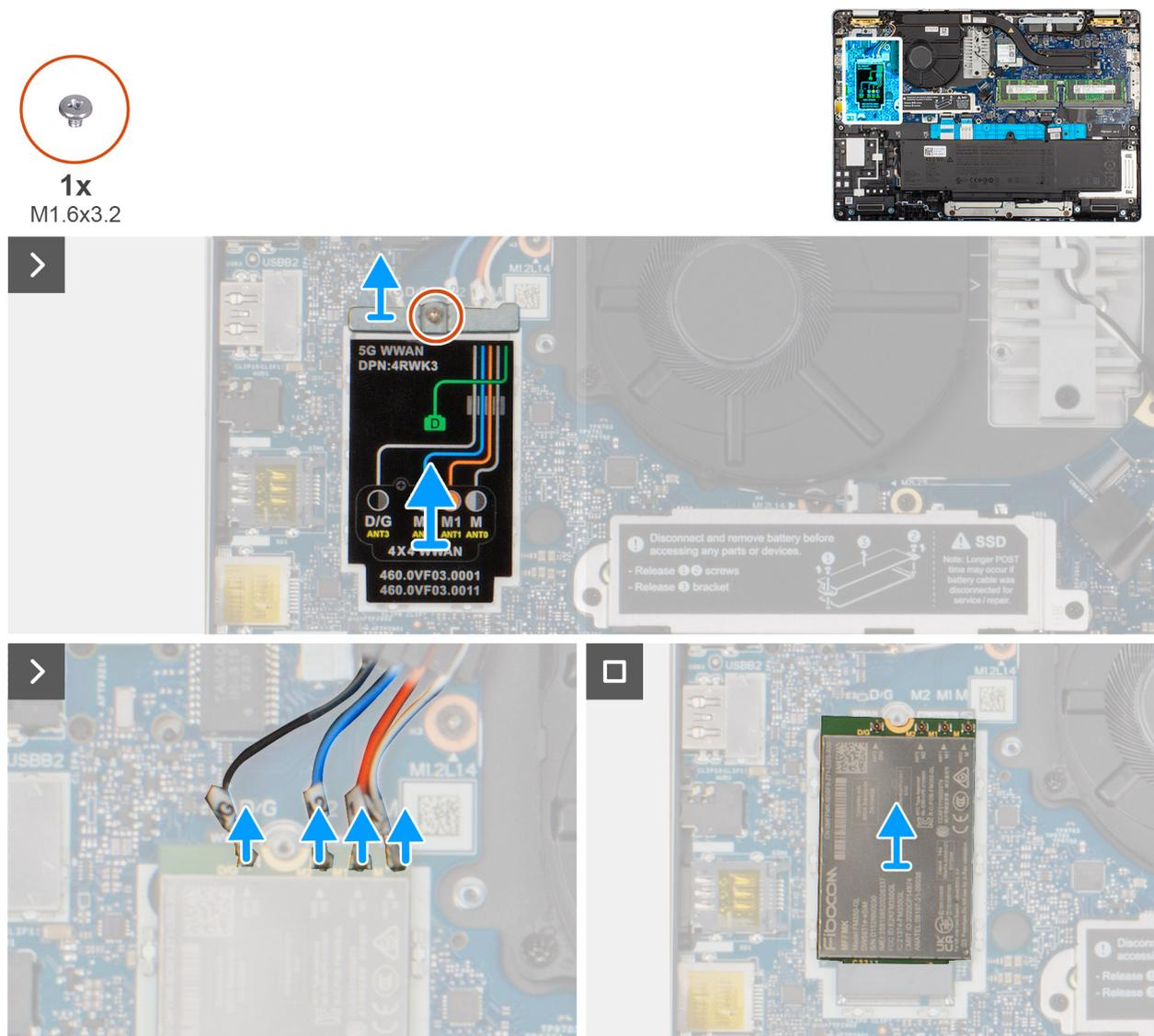
Abbildung 28. Entfernen der 5G-WWAN-Karte
