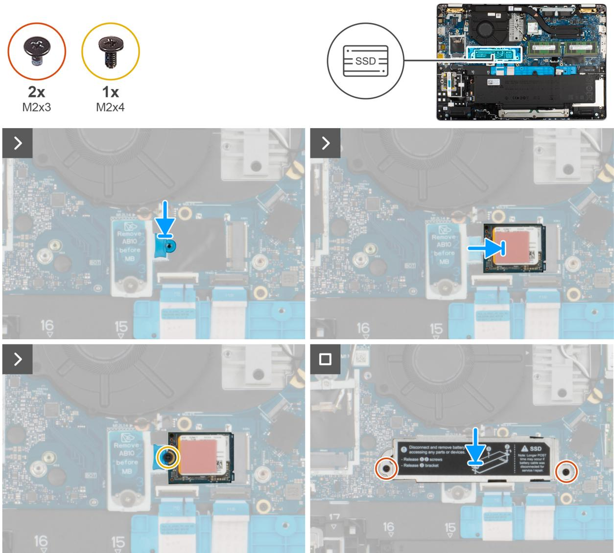
Abbildung 23. Einbauen des M.2-2280-SSD
