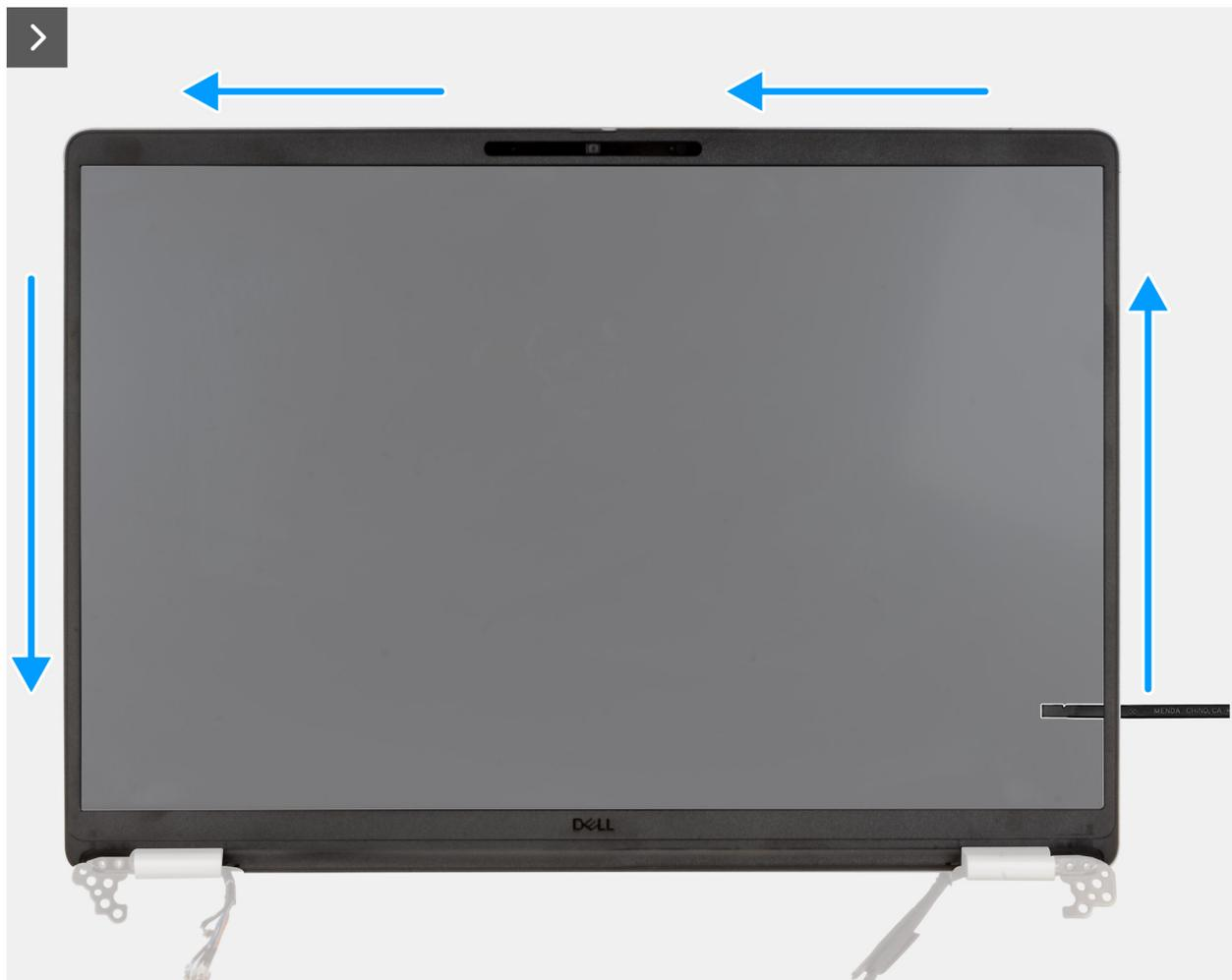
Abbildung 61. Entfernen der Bildschirmblende
