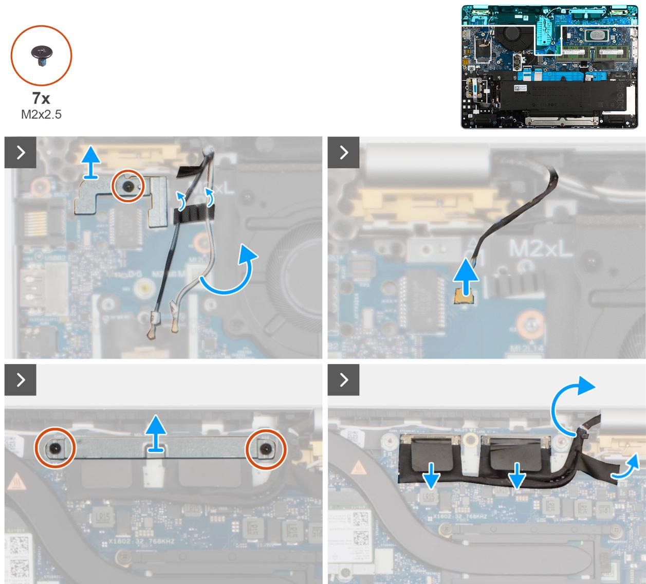
Abbildung 39. Entfernen der WLAN-Antenne
