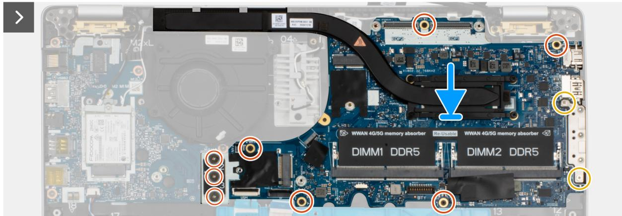
Abbildung 50. Einbauen der Systemplatine
