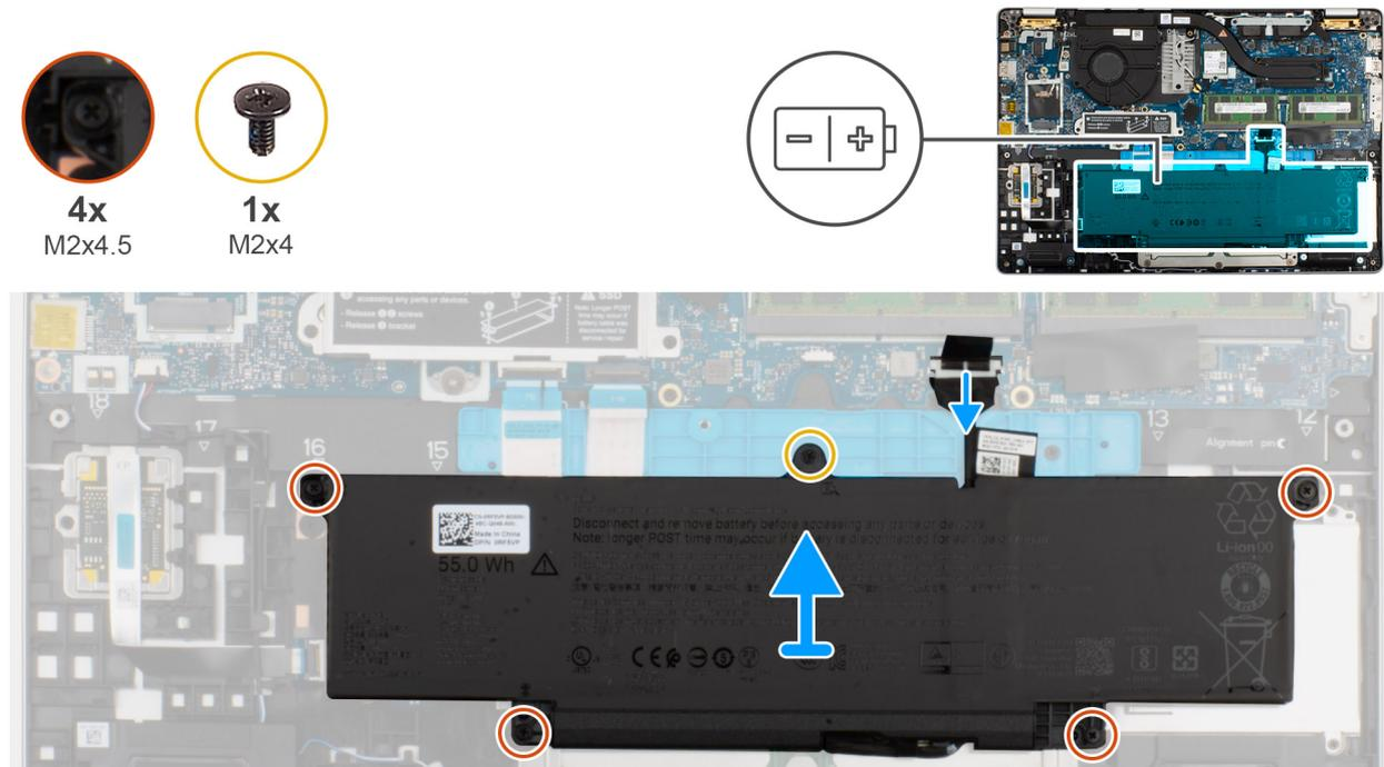
Abbildung 16. Entfernen des Akkus
