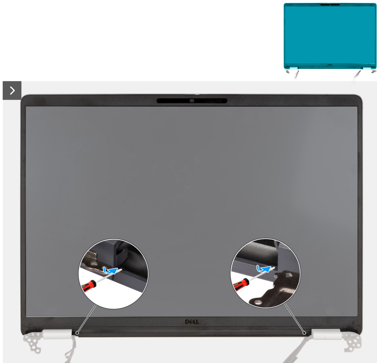
Abbildung 59. Abhebeln der Kunststoffblende
