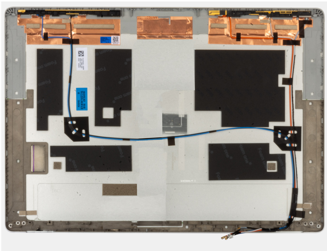
Abbildung 76. Einbauen der hinteren Bildschirmabdeckung
