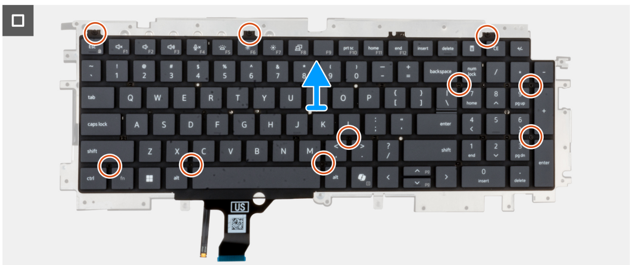
Abbildung 85. Entfernen der Tastatur
