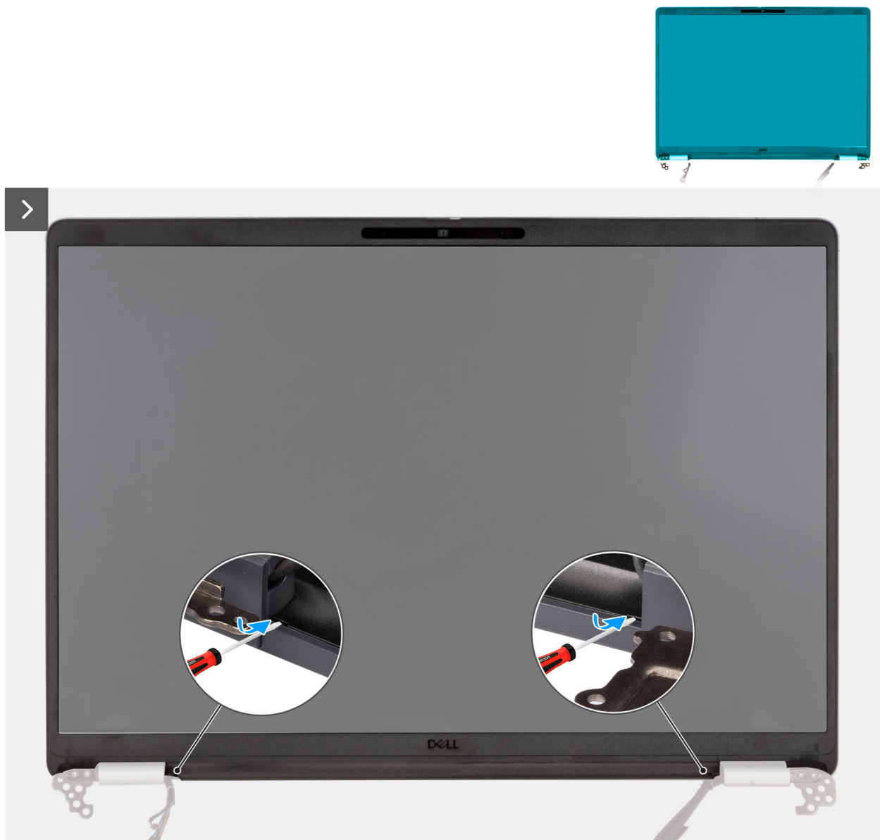
Abbildung 64. Abhebeln der Kunststoffblende
