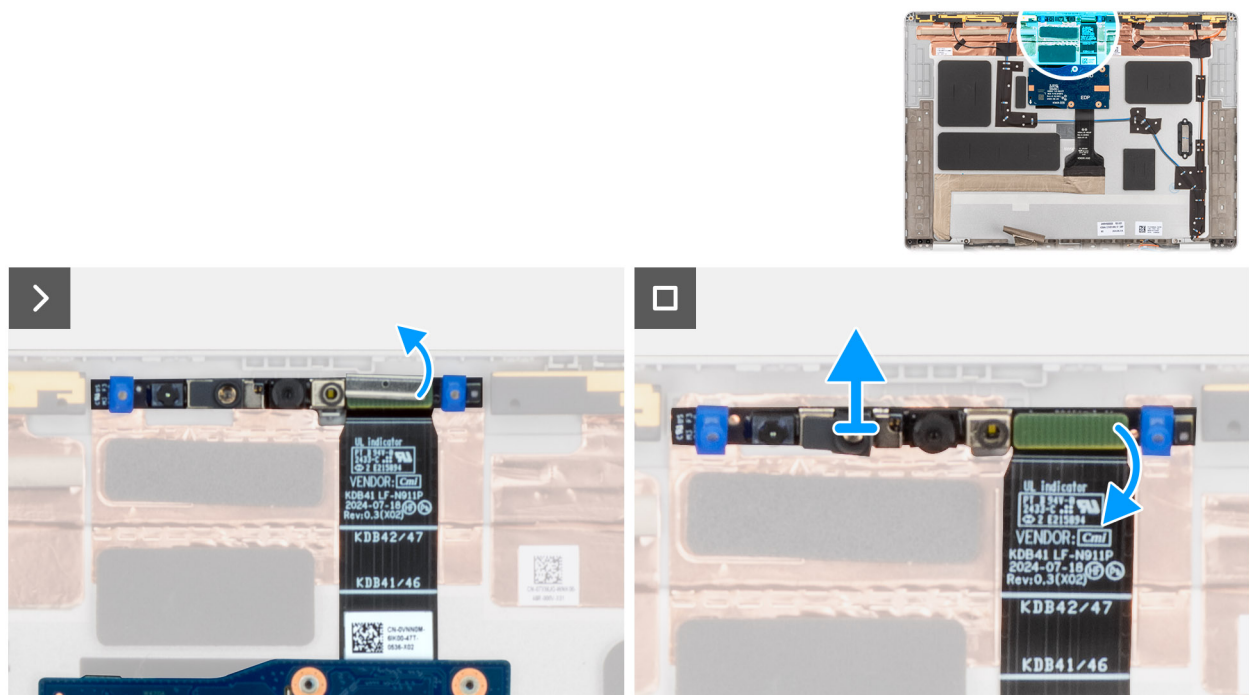
Abbildung 79. Entfernen der MIPI-Kamera
