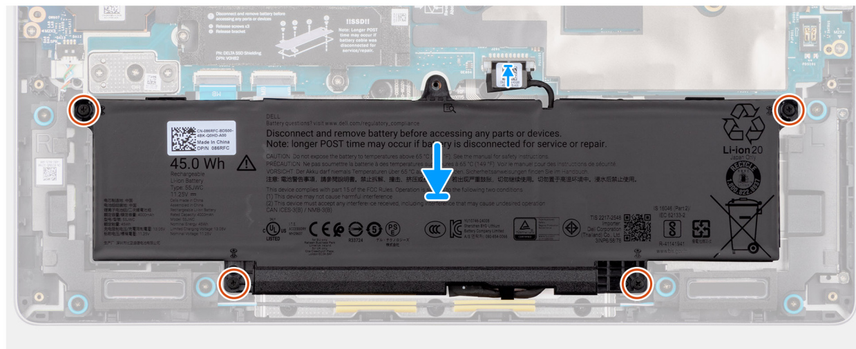
Abbildung 22. Einsetzen des Akkus
