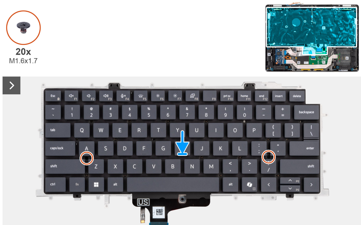
Abbildung 95. Einbauen der Tastatur
