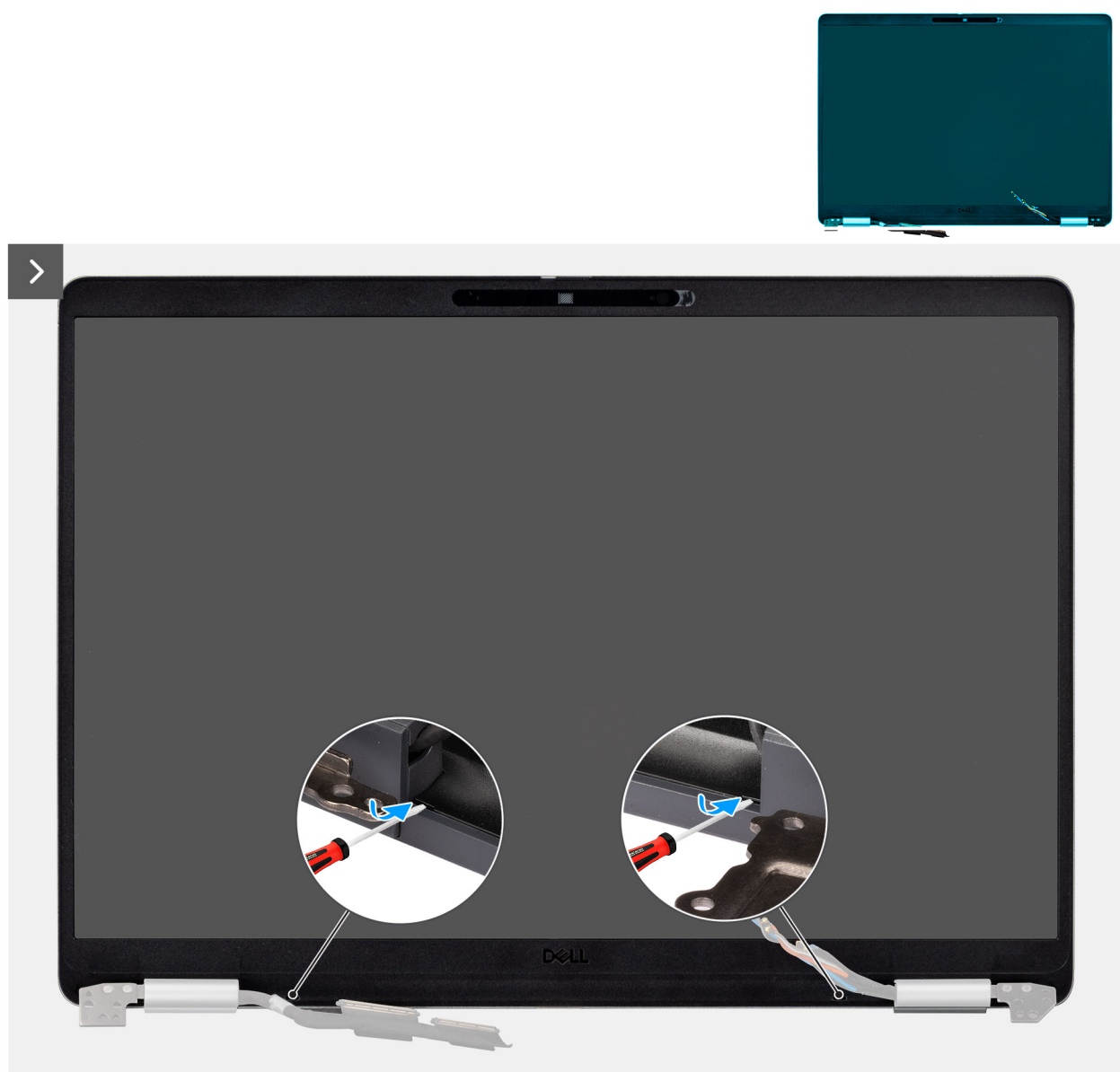
Abbildung 61. Abhebeln der Kunststoffblende
