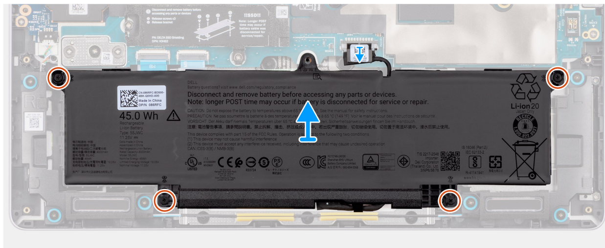
Abbildung 21. Entfernen des Akkus
