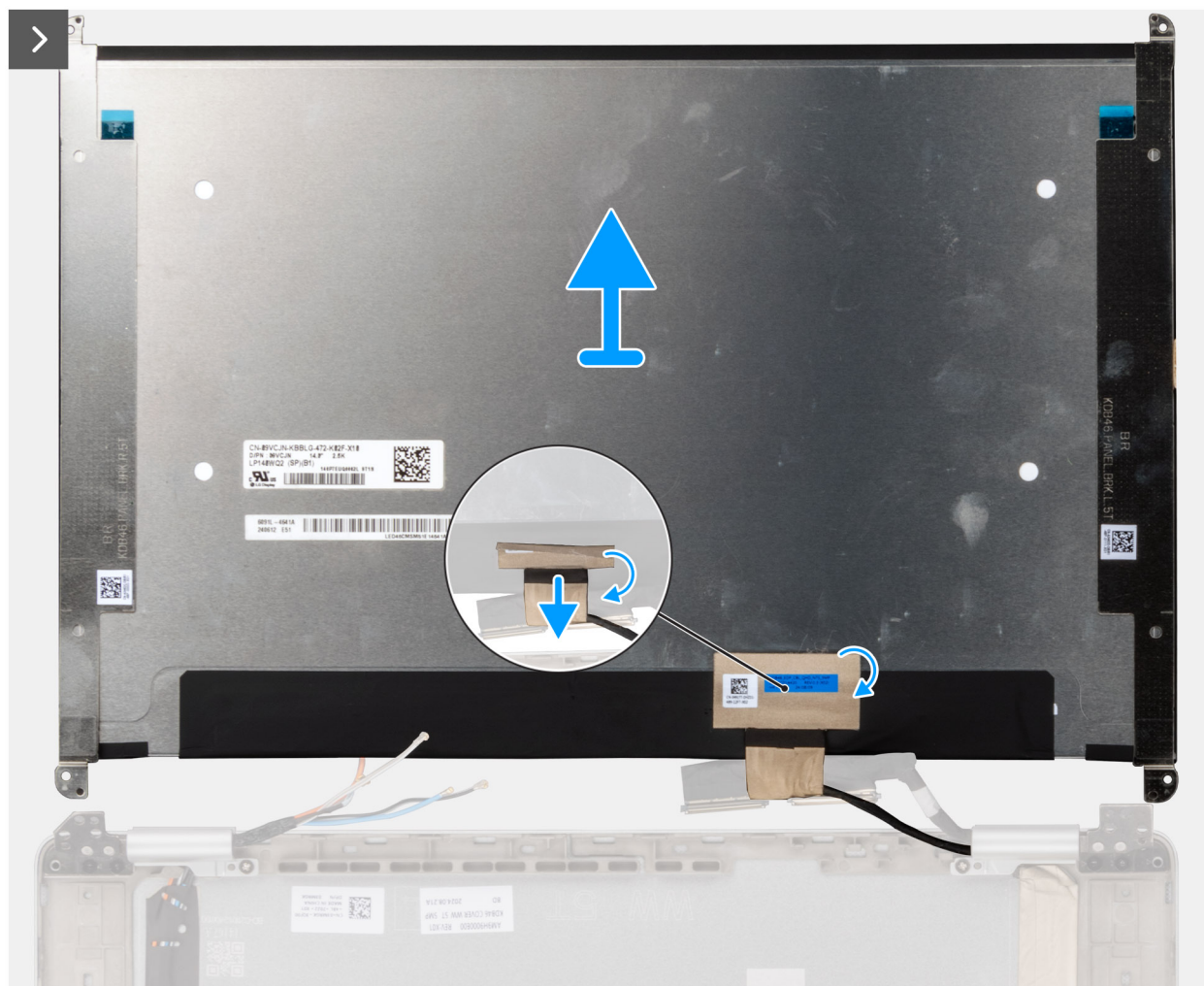
Abbildung 69. Entfernen des Bildschirms
