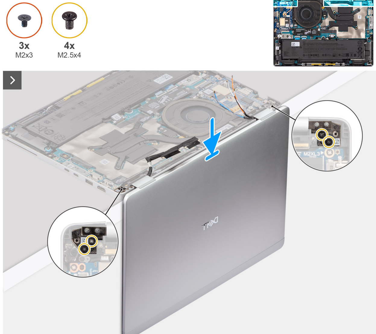
Abbildung 59. Ausrichten der Bildschirmbaugruppe an der Handauflagenbaugruppe
