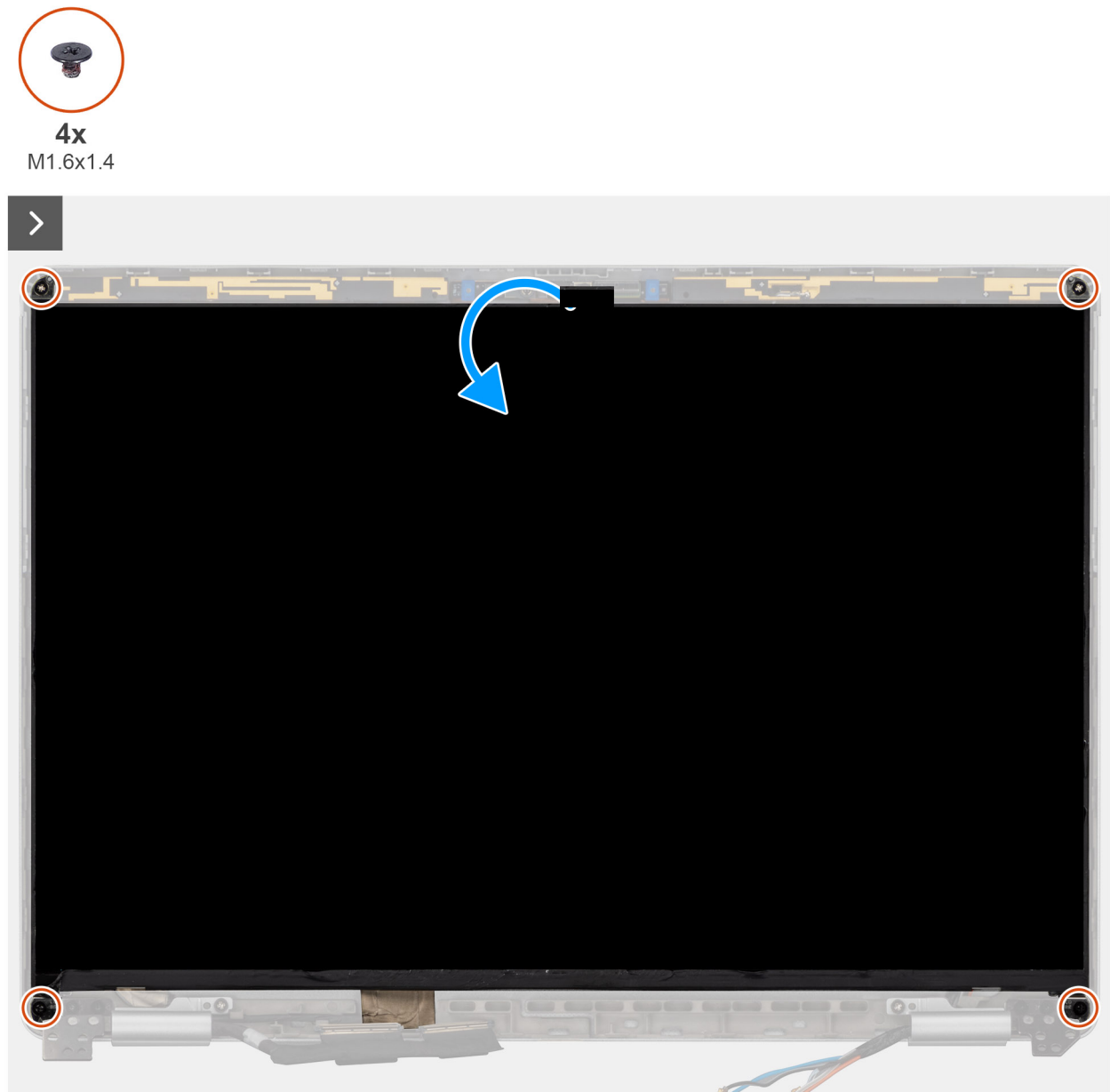
Abbildung 68. Entfernen des Bildschirms
