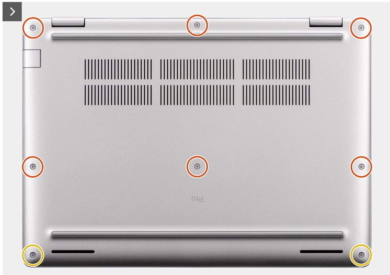
Abbildung 17. Entfernen der Bodenabdeckung
