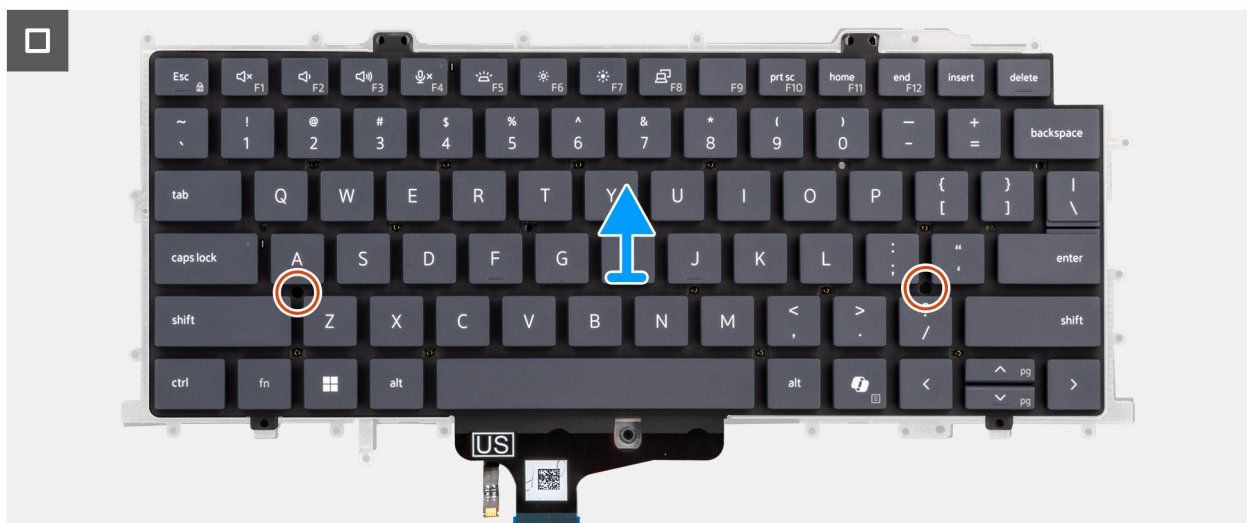
Abbildung 94. Entfernen der Tastatur
