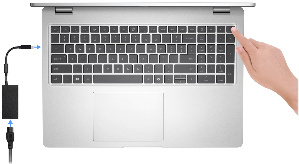
Abbildung 11. Anschließen des Netzteils und Drücken des Netzschalters
