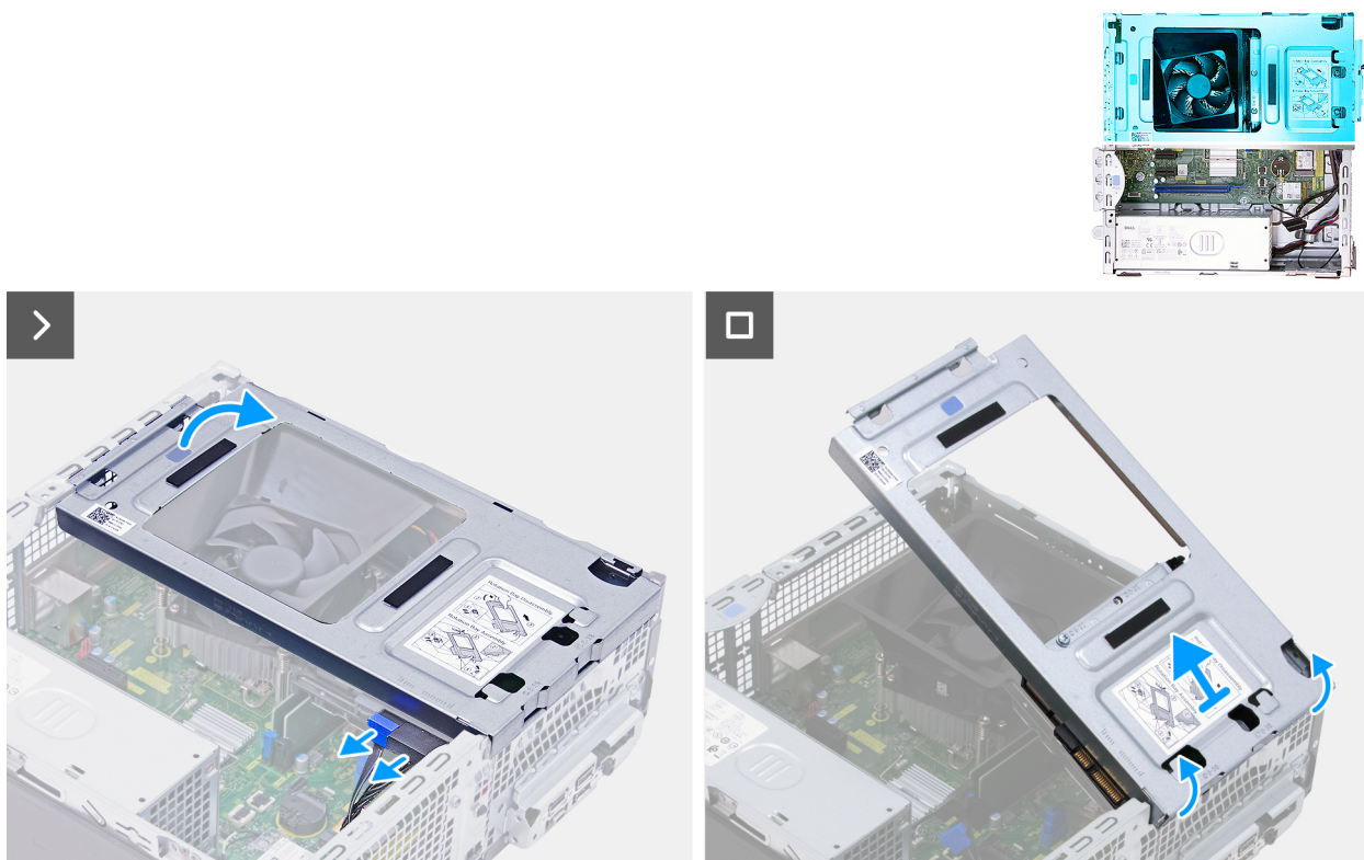
Rysunek 19. Wymontowywanie kieszeni obrotowej
