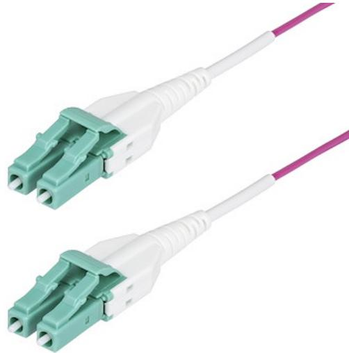
Dieses OM4 LC zu LC Multimode Duplex Glasfaser-Patchkabel bietet zuverlässige Konnektivität in 40 und 100 Gigabit Netzwerken. Der TIA-konforme Erika-Violett-Mantel unterscheidet OM4- von Aqua-OM3/OM4-Verkabelung und macht das Rätselraten in kritischen Netzwerken überflüssig. Das kompakte Uniboot-Steckerdesign ermöglicht ein einfaches Einstecken und Entfernen in Installationen mit hoher Dichte.
